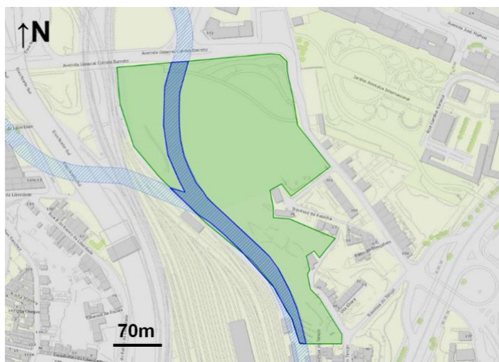
Figura 15 - Esquema da junção dos 2 ramos do caneiro - planta, escala 1/2000 (Adaptado Lxi – lisboa interativa)
