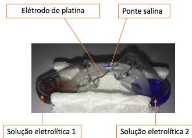
Figura 25-Fotografia a exemplificar a montagem das células 1 e 2
