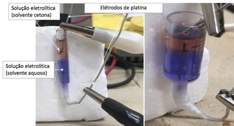
Figura 27-Montagem da célula com dois solventes (água e cetona imiscível); Célula com 0,5 cm de diâmetro à esquerda e célula com 0,8 cm de diâmetro (à direita)
