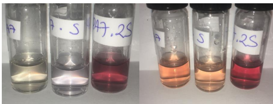
Figura 20-Fotografias das amostras VPAb, VPAS, VPA2S após a adição do oxidante (à esquerda) e algumas horas depois (à direita)
