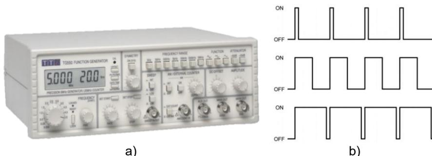
Figura 10: a) Gerador de funções TTI TG550 e b) tipo de pulso utilizado.
