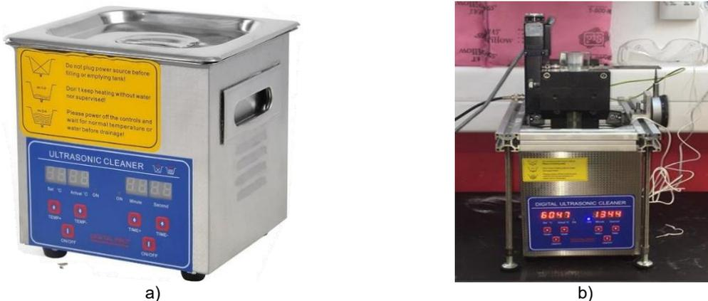
Figura 23: Limpeza assistida por ultrassons: (a) tanque de ultrassons PS-10A da JARCOM e (b) integração com a estrutura da máquina de ensaios.
