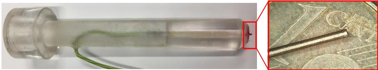
Figura 18: Pinça de fixação do respectivo eletrodo.
