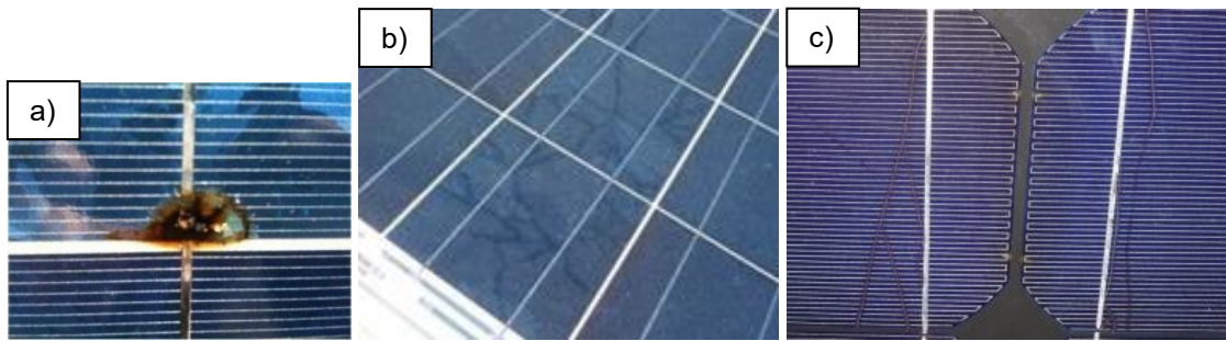
Figura 5-6: a) Ponto quente [79]; b) Snail-track [80] ; c) Células quebradas [81].
