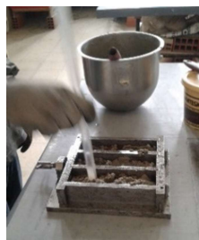
Figura 3.3 - Compactação da argamassa
