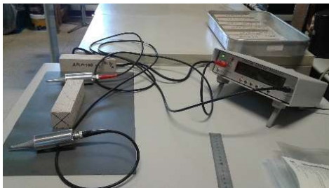
Figura 3.7 - Equipamento de medição de ultrassons
