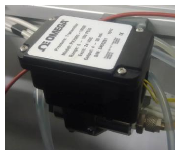
Fig. 3.7 – Sensor diferencial de pressão PX2300-10DI e PX2300-100DI. Especificações:
