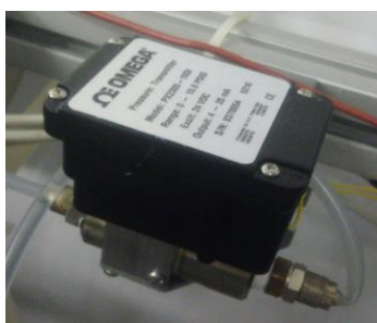
Fig. 3.7 – Sensor diferencial de pressão PX2300-10DI e PX2300-100DI. Especificações:
