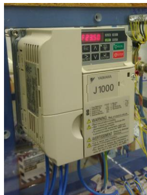
Fig. 3.5 – Conversor de frequência. Especificações:
