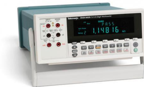
Fig. 3.11 – Multímetro digital utilizado para medir a diferença de potencial na secção de teste. Especificações: https://www.tek.com/link-click-count?nid=72376&url=http%3A//download.tek.com/datasheet/Tektronix-DMM4020-Digital-Multimeter-Datasheet-6.pdf
