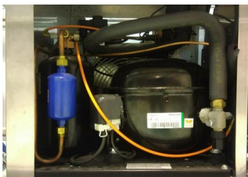
Fig. 3.9 - Unidade de refrigeração. Especificações: http://www.embraco.com/catalog/pdfs/FT003488_1.pdf
