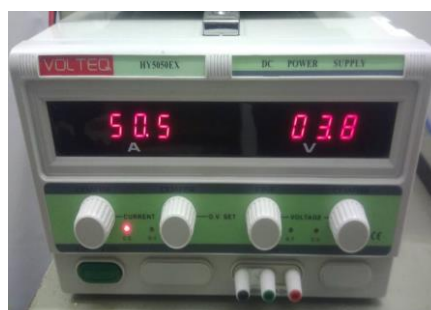
Fig. 3.10 – Fonte de Alimentação DC. Especificações: http://www.volteq.com/volteq-power-supply-hy5050ex-50v-50a-over-voltage-over-current-protection-110v-input.html .
