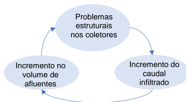
Figura 2.4.2- Ciclo de deterioração dos sistemas de drenagem de águas residuais devido às infiltrações indevidas
