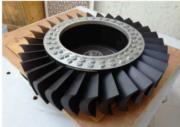
Figura 2.8: Rotor da turbina de ação axial a usar na estação V-Flow.
