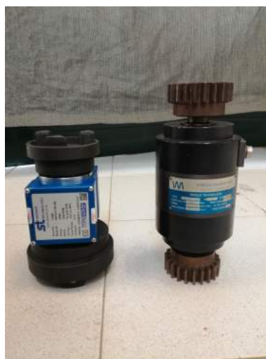
Figura 4.9: Sensores de binário e velocidade de rotação: esquerda (RWT411-DE-KB), direita (TG-5/BP).
