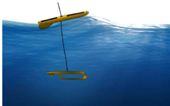
(b) Representação do sistema dos dois corpos do Wave Glider (retirado de [8]).
