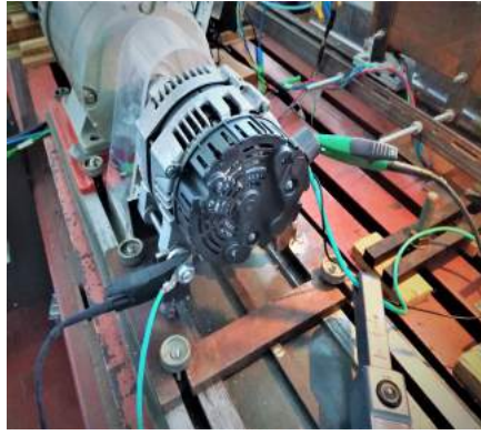
(b) Pinças de medição de corrente e de tensão do gerador.
