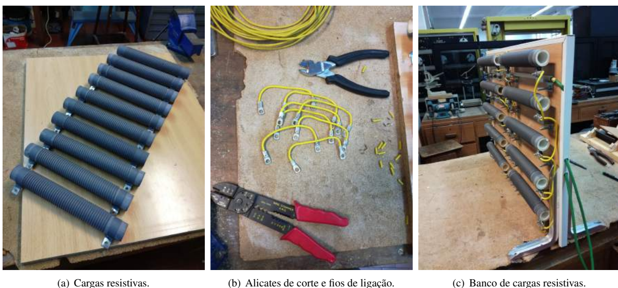
Figura 3.2: Construção do banco de cargas resistivas.
