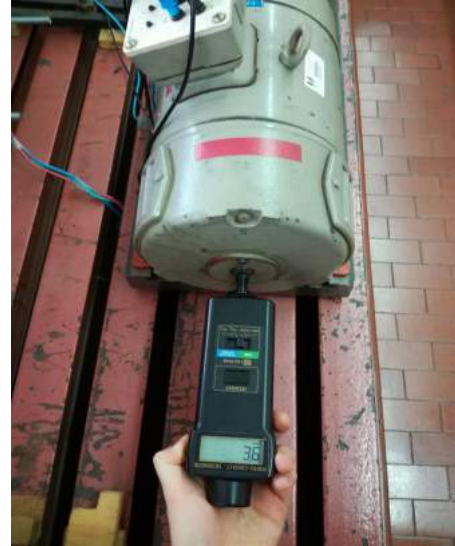
(b) Ponto de medição da velocidade de rotação do motor CC.
