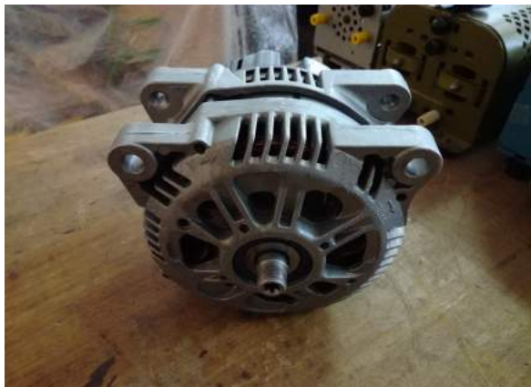
(a) Furos de suporte do gerador.
