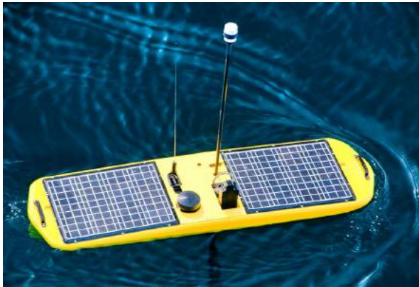
(a) Módulos solares e luz de sinalização do Wave Glider (retirado de [8]).
