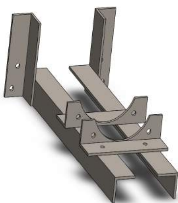
(a) Suporte de fixação ao gerador e sensor de binário.
