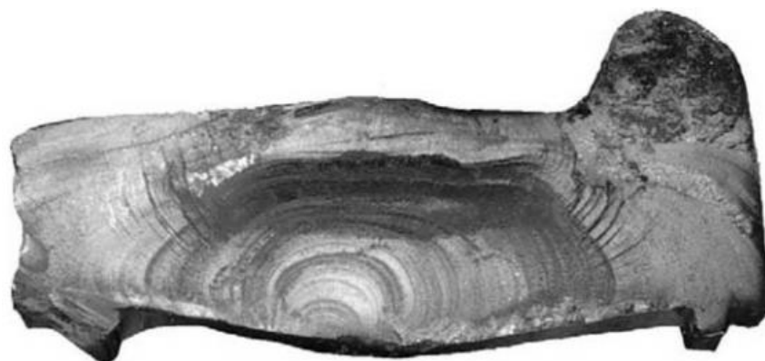
Figura 1.3: Superfície de fractura de uma roda de comboio [3].
