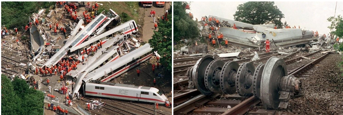
Figura 1.2: Imagem do acidente ferroviário na Alemanha (esquerda) e pormenor do bogie que se soltou da carruagem (direita), [2].
