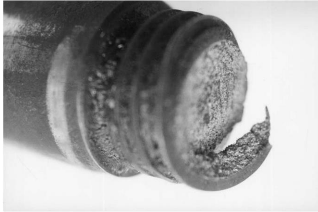
Figura 1.1: Superfície de fractura de um parafuso de união de um atrelado [1].
