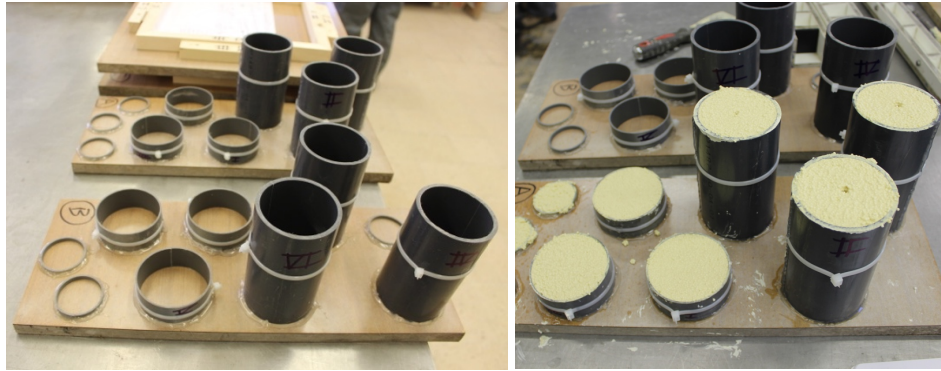
Figura 3.2: Provetes cilíndricos para utilização do equipamento ISOMET e disco de Lee, à esquerda por preencher e à direita já preenchidos
