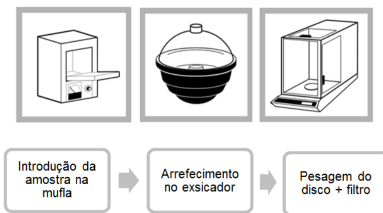
Figura 4.6 – Procedimento realizado para o cálculo dos SSV (adaptado de APHA, 1999)
