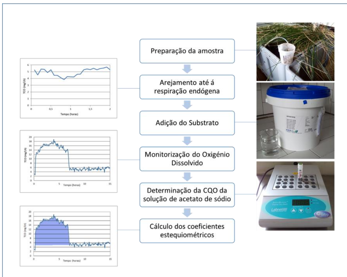
Figura 4.7 – Esquematização das etapas envolvidas num ensaio respirométrico
