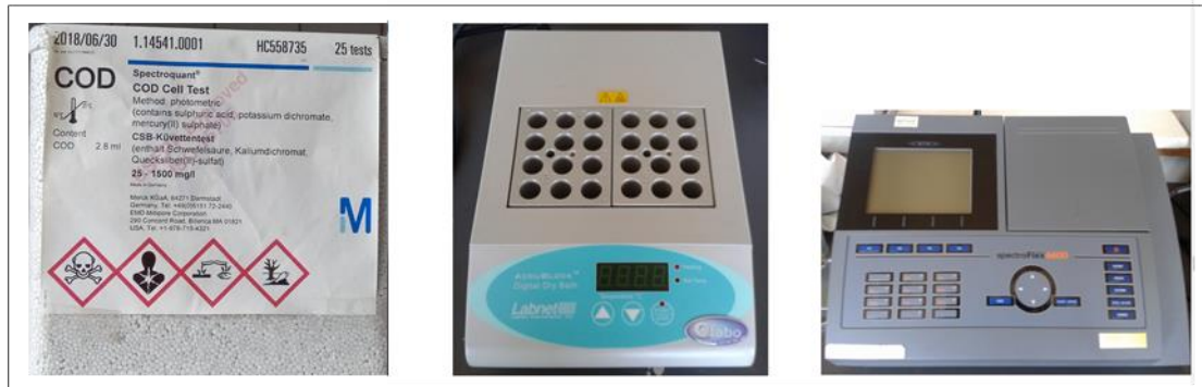
Figura 4.4 – Equipamento utilizado na leitura da CQO. Da esquerda para a direita: testes 25-1500mg/L, MERCK, AccuBlock™ Digital Dry Baths e spectroFlex series 6600 (Pisoeiro J. , 2013)
