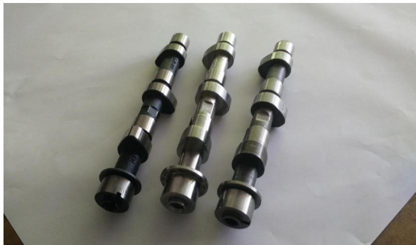
Figura 3.16 - Árvores de cames (da esquerda para a direita): original, Dwell 45 e Dwell 50
