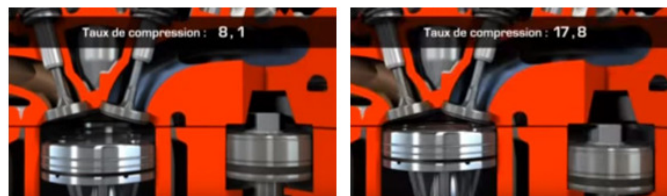
Figura 2.10 - Variação do deslocamento máximo do pistão com o atuador (adaptado de [22])
