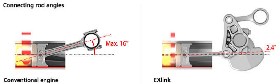
Figura 2.21 - Comparação entre os ângulos máximos de biela num motor convencional e no EXlink (adaptado de [39])
