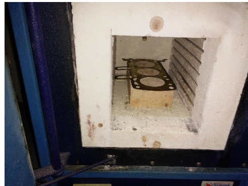
Figura 3.19 – Amaciamento da junta da cabeça para resolver o problema de perda de pressão
