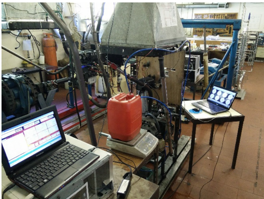
Figura 3.41 - Sistema de aquisição de dados, com os dois computadores, a balança digital e a placa de aquisição do sinal da célula de carga
