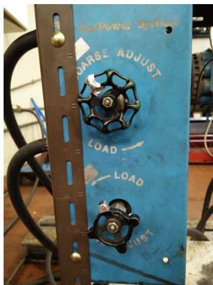
Figura 4.2 - Torneiras de controlo de caudal de água no freio. Em cima de controlo grosso e em baixo de controlo fino
