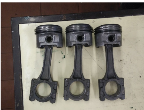
Figura 3.20 – Pistões removidos para instalação de novos segmentos
