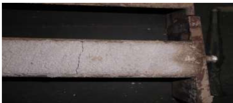
Figura 5.9 - Fissuração do provete da argamassa PCM-SB-1, no ensaio de cantoneira.
