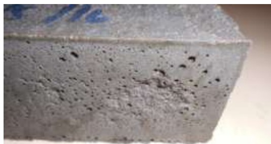
Figura 5.11 – Pormenor da face lateral do provete da argamassa PCM-SB-5, com muita porosidade superficial.
