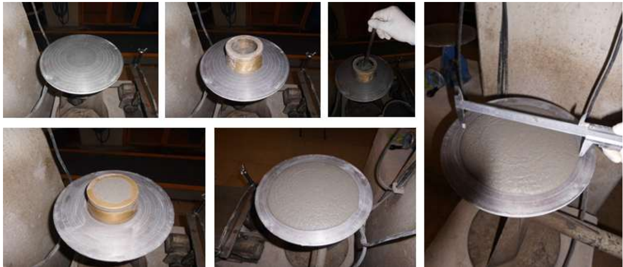
Figura 4.7 – Diferentes fases da realização do ensaio de consistência por espalhamento.
