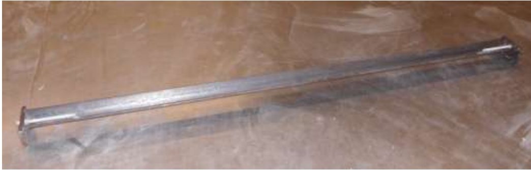
Figura 4.17 – Cantoneira para avaliação da retracção restringida.
