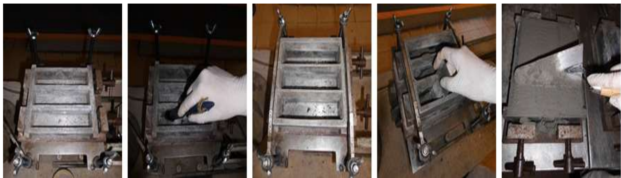
Figura 4.22 - Figura 4.23 - Fases da elaboração de provetes prismáticos de argamassa.
