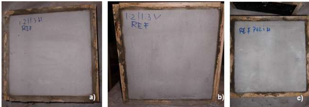
Figura 5.5 - Argamassa PCM-SB-5 aplicada em lajetas representativas de pavimento (a), parede (b) e tecto (c).
