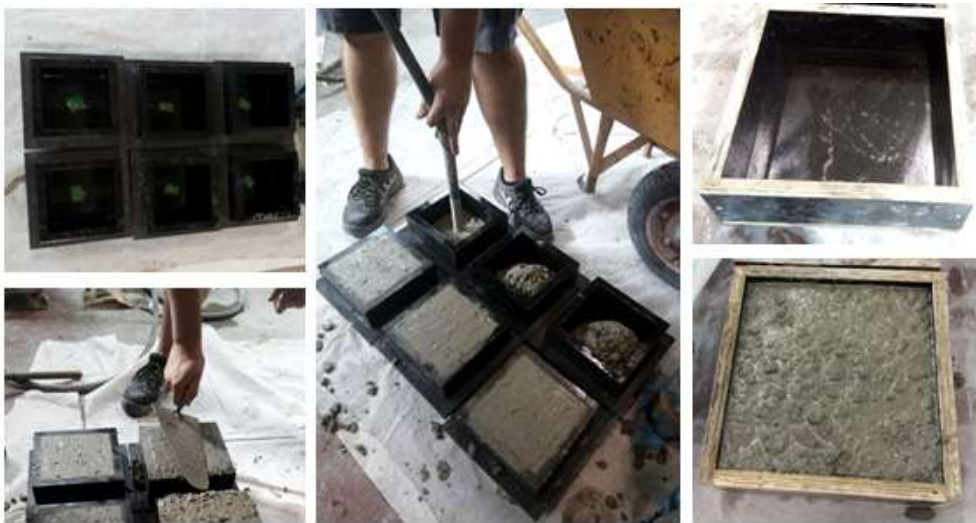
Figura 4.5 – Diferentes fases da produção dos cubos e lajetas de betão
