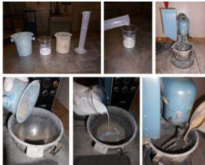
Figura 4.4 - Materiais e equipamento para a elaboração de uma argamassa em laboratório.
