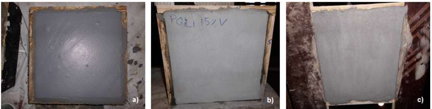
Figura 5.6 - Argamassa CM-1.2 aplicada em lajetas representativas de pavimento (a) e parede (b) e argamassa CM-5 aplicada em pavimento (c).
