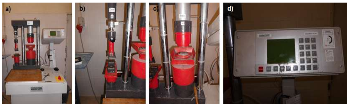
Figura 4.24 - Equipamento para realização do ensaio de flexão-compressão (a), equipamento para o ensaio de flexão (b), equipamento para o ensaio à compressão (c), leitor de medições (d).
