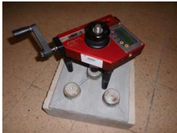
Figura 4.18 - Equipamento para o ensaio de "Pull-off".
