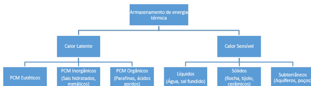
Figura 2-5 – Tipos de armazenamento de energia térmica.
