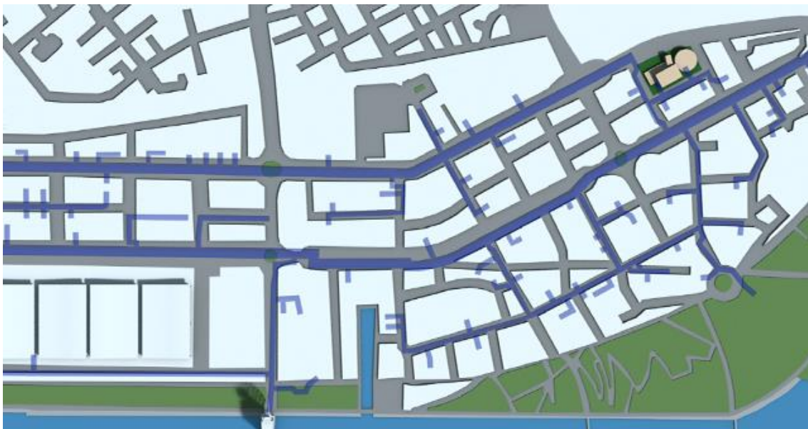
Figura 5-1 – Rede de distribuição de frio da CLIMAESPAÇO.
