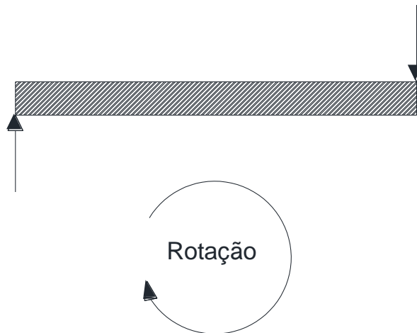
Figura 1.2 - Sistema de forças em equilíbrio mas sem equilíbrio de momentos fletores
