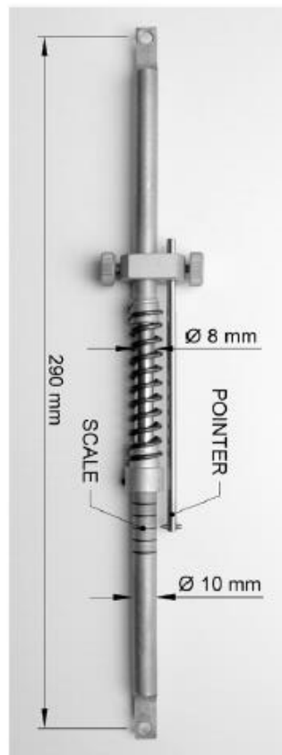
Figura 5.7 - Dimensões dos elementos da treliça retirado de [1]
