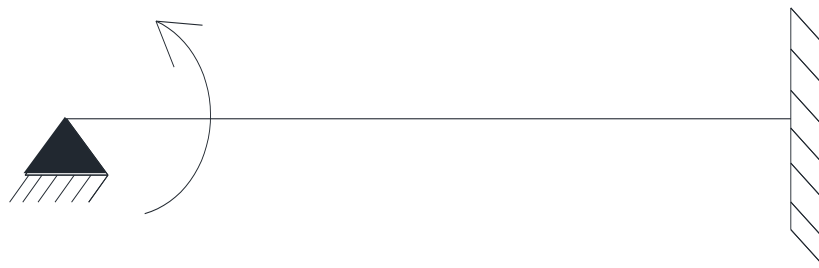
Figura 4.1 - Viga encastrada-apoiada com momento fletor aplicado no apoio simples
