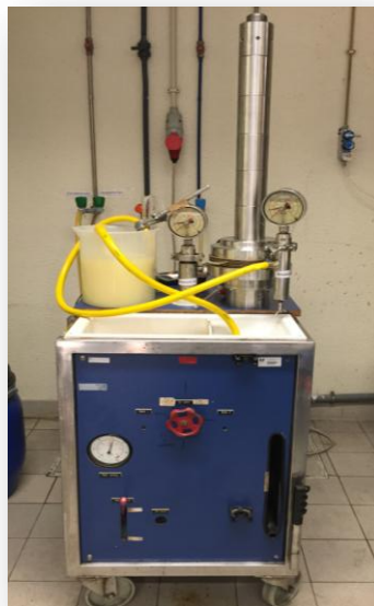
Figura 12 – Instalação piloto de permeação.
