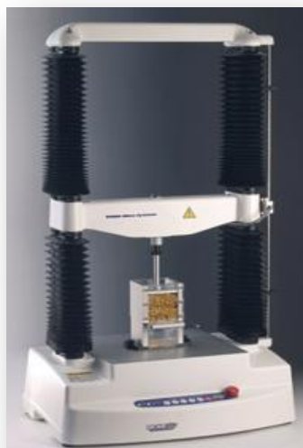
Figura 15 – Texturómetro utilizado na determinação das propriedades texturais dos requeijões.
