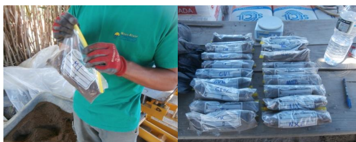
Figura 28 - Processo de recolha de amostra de mistura húmida para cálculo do teor de humidade de produção
