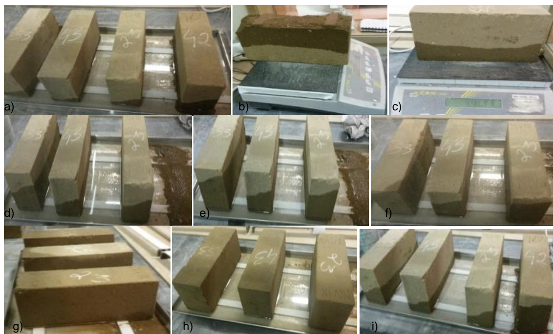
Figura 63 – Ensaio de absorção capilar: Ordem das misturas na figura: M,C,M,N (esquerda para a direita). Tempo de ensaio: a) 5 minutos; b) 10 minutos (Mistura N); c) 10 minutos (mistura C); d) 20 minutos; e) 60 minutos; f) 2 horas; g) 6 horas; h) 24 horas; i) 72 horas.
