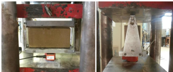
Figura 37 – Esquema de ensaio de resistência à compressão diametral (vista frontal e lateral).
