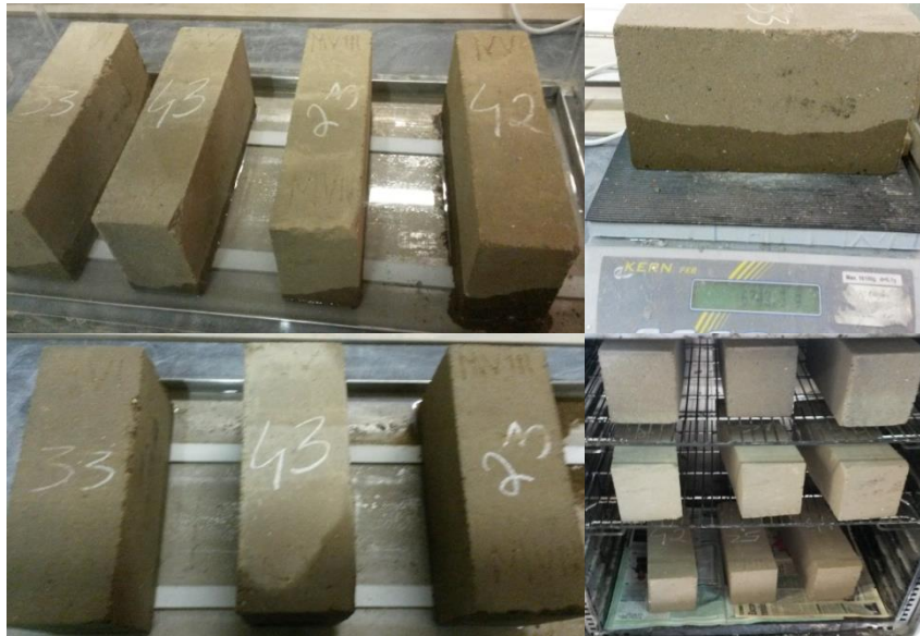
Figura 45 - Procedimento do ensaio de absorção de água por capilaridade.
