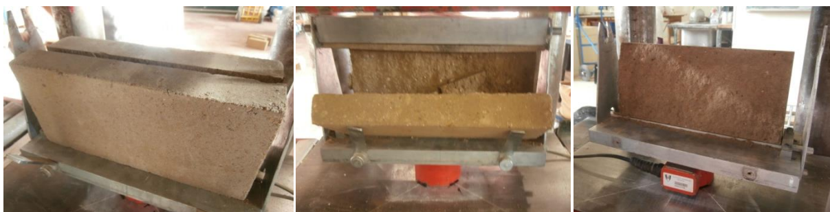
Figura 38 - Exemplificação da rotura dos provetes por compressão diametral.
