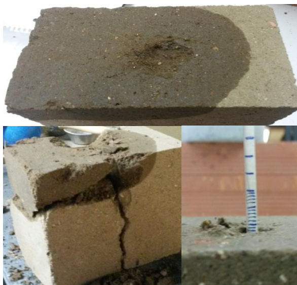
Figura 65 - Efeito do gotejamento nos blocos da mistura N
