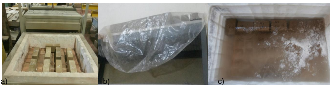
Figura 33 - Condicionamento dos provetes: a) Seco (no forno). b) Húmido (Camara húmida). c) Saturado (água turva devido à desagregação dos provetes N)
