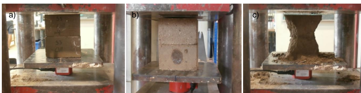
Figura 35 – Ensaio de compressão: a) Provete centrado pré-ensaio. b) Vista de lado de provete centrado pré-ensaio. c) Provete pós-ensaio.
