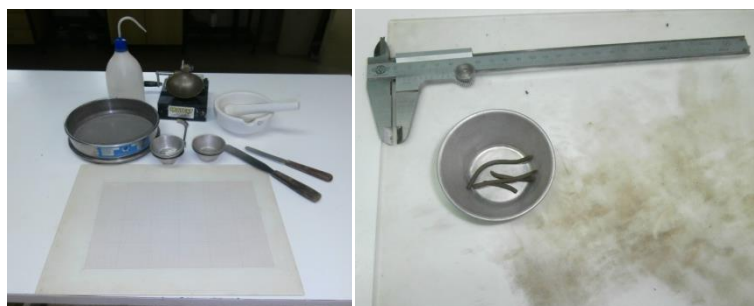
Figura 21 - Equipamento utilizado para a determinação dos limites de consistência.
