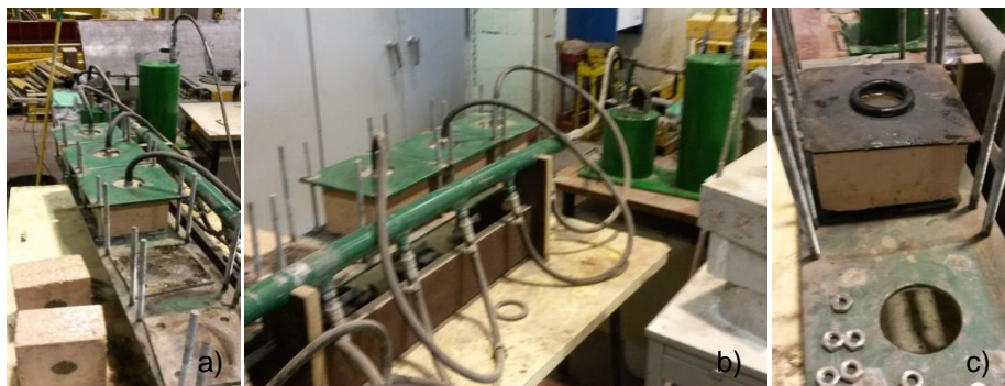
Figura 42 –Ensaio de permeabilidade a) e b) Equipamento de permeabilidade com alguns provetes colocados. c) Pormenor de colocação de um provete.
