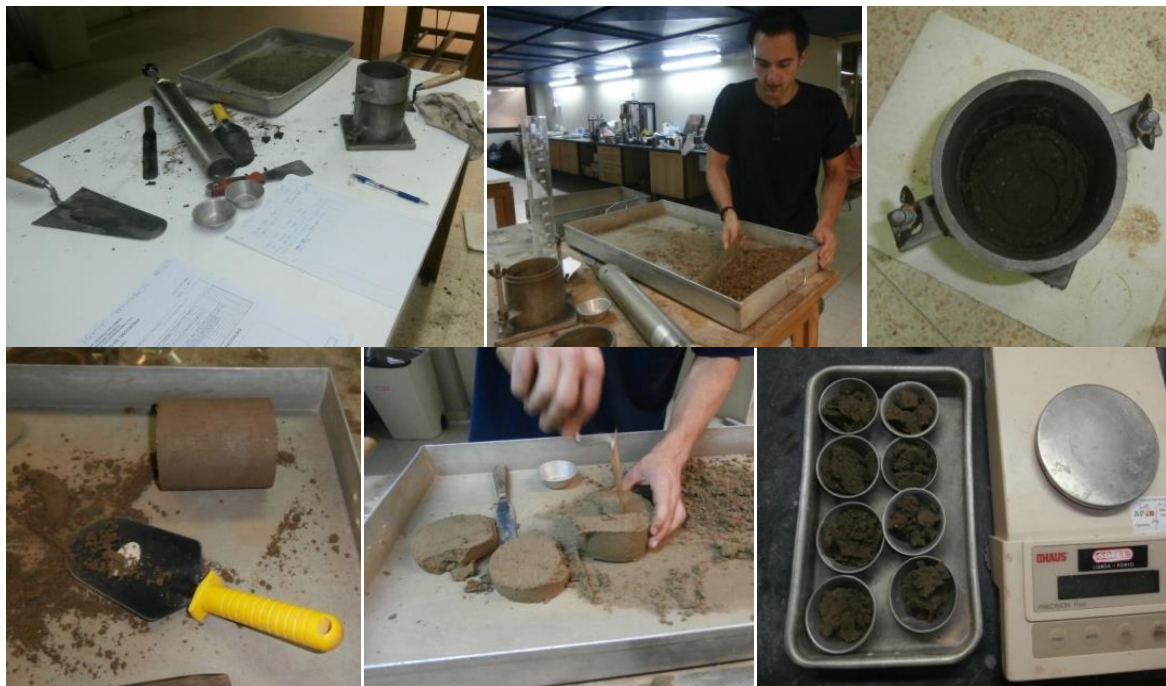
Figura 24 - Várias fases do ensaio Proctor com diferentes amostras de terras.
