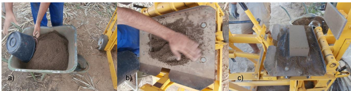
Figura 16 - a) Dosagem da mistura. b) Colocação da mistura na prensa. C) Moldagem do bloco.
