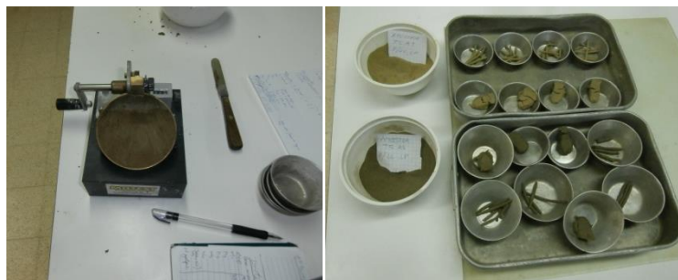
Figura 22 - Ensaio de determinação dos limites de consistência.
