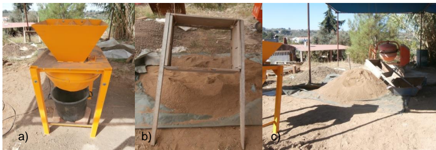
Figura 14 – Equipamento e material utilizado na produção: a) Pulverizador mecânico de pás. b) Peneiro com 4mm de abertura. c) Terra após pulverização e peneiração.
