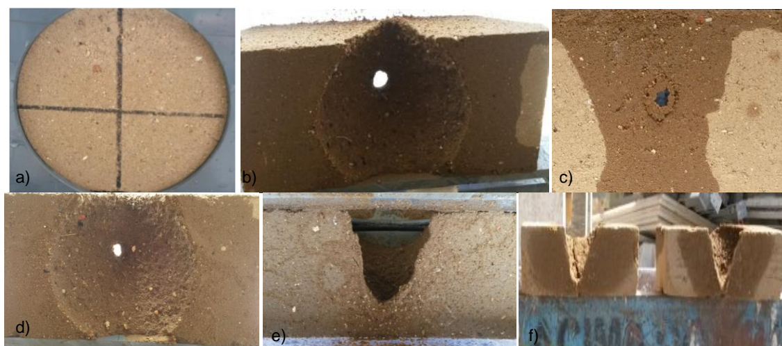
Figura 67 – Erosão acelerada - mistura não estabilizada: a) Mistura N antes do ensaio; b) Mistura N após rotura (Vista frontal); c) Mistura N após rotura (Vista posterior); d) Mistura N após rotura (Vista frontal); e) Mistura N após rotura (Vista superior); f) Provetes da mistura N após ensaio.
