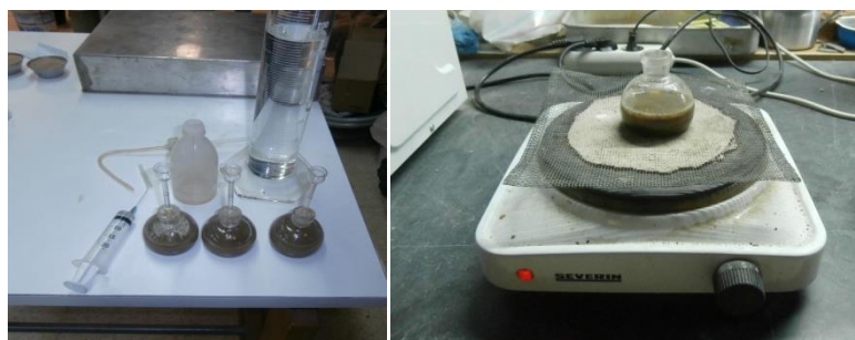
Figura 23 - Ensaio de determinação da massa volúmica das partículas.
