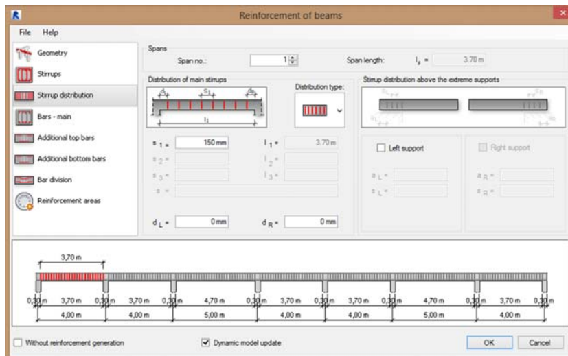
Figura 73 - Definição da distribuição dos estribos por vão
