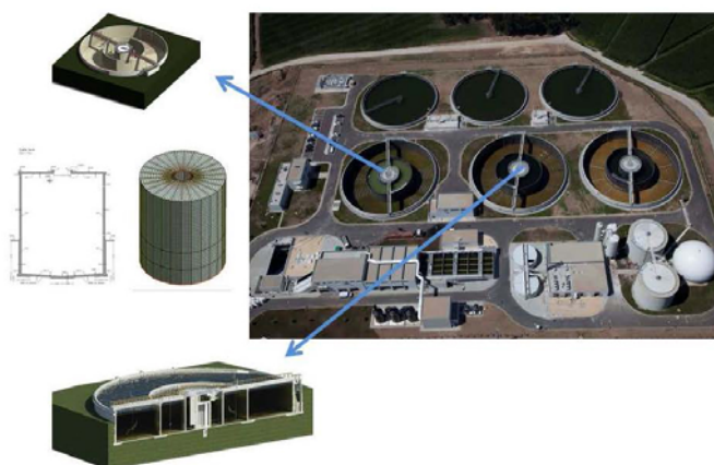
Figura 12 - ETAR do Ave: interacção colaborativa entre o projecto do processo de tratamento e o projecto de fundações e estruturas (Lino, J. et al, 2012)
