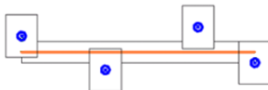
Figura 24 – Representação em planta de problemas de compatibilidade geométrica entre o modelo físico e modelo analítico (retirado de [27])
