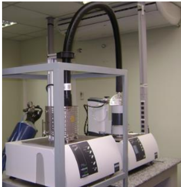
Figura 3.3 Sistema de termobalança de alta precisão acoplado a detector de massa em linha para aplicação de ensaios de DeSO x nas condições de FCC.
