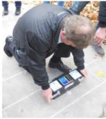
Figura 2.17 – Inspeção realizada com o tomógrafo Mira [Germann Instruments, 2011]
