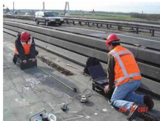
Figura 2.30 – Varrimento da laje [Catalog NTD, 2010]
