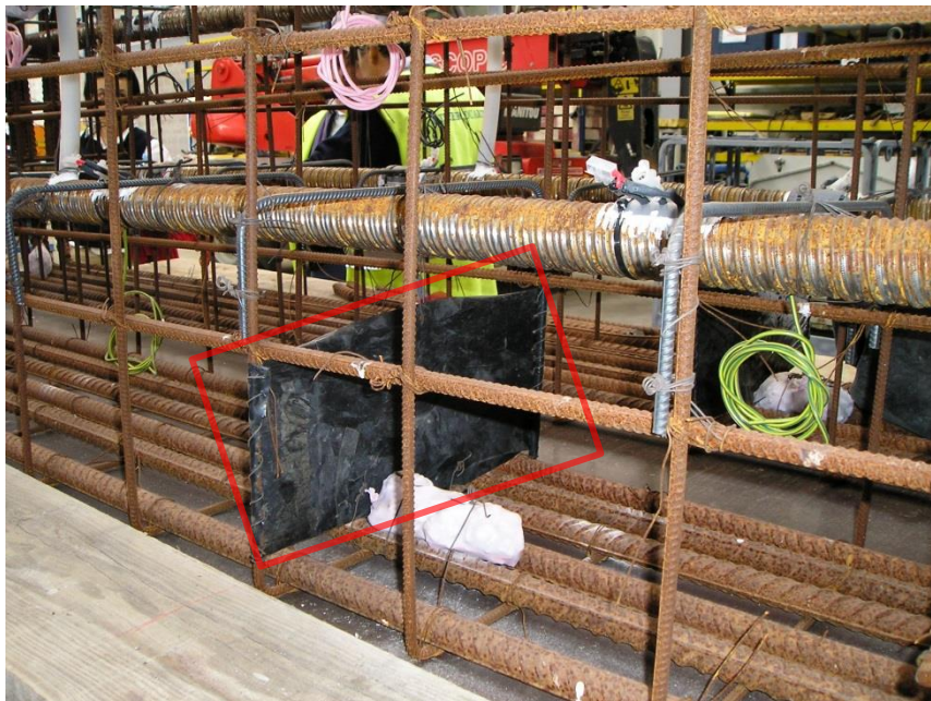
Figura 3.12 – Lâmina de plástico assinalada a vermelho que simulou uma fissura. [Almeida et al., 2013]
