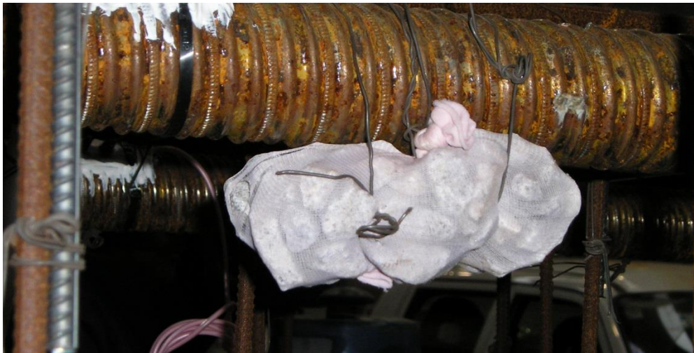
Figura 3.13 – Simulação de um ninho de britas. [Almeida et al., 2013]
