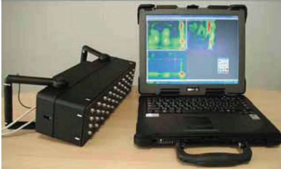
Figura 3.26 – Antena e computador portátil com o programa de controlo e análise instalado [Catalog NDT, 2010]
