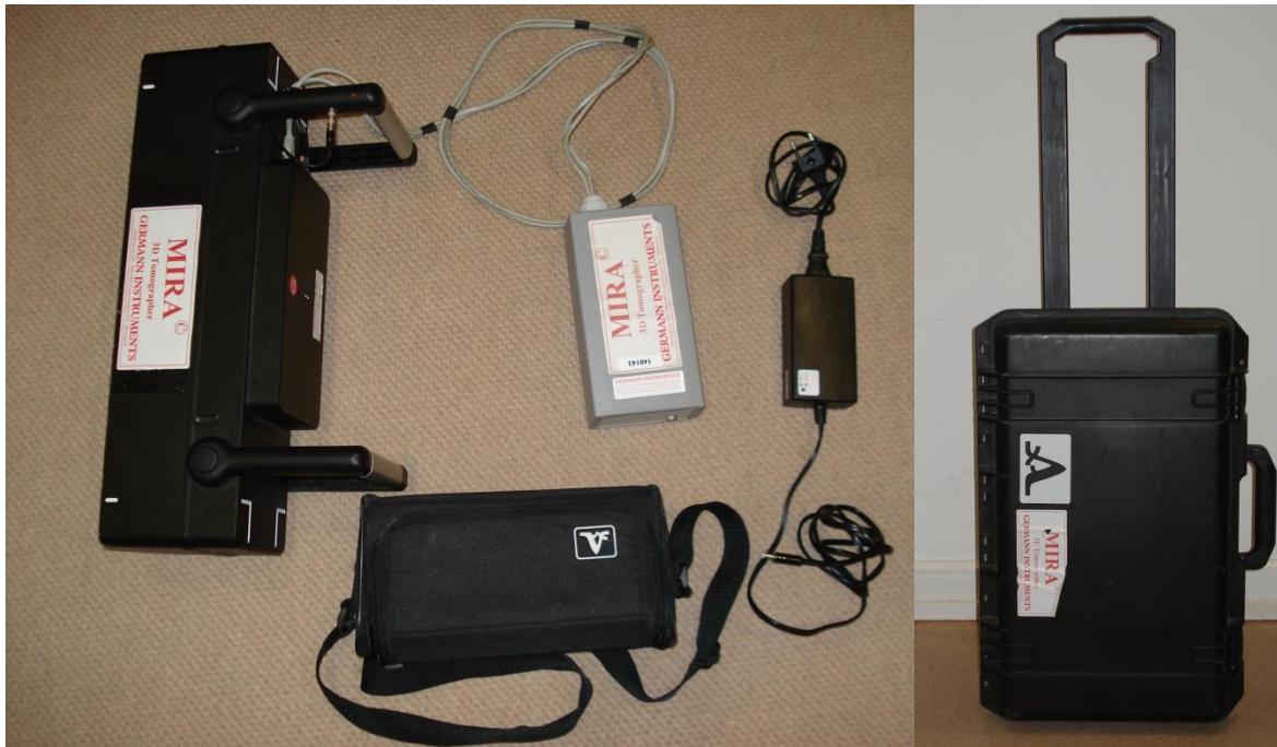
Figura 3.22 – Antena com a matriz de 10x4 transdutores de onda de corte a baixa frequência, bateria autônoma e bolsa para transporte, carregador da bateria e cabo de alimentação, caixa de transporte
