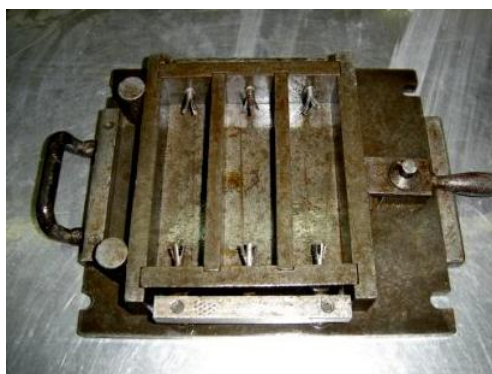
Figura 3.7 - Molde com pernos metálicos montados
