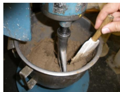
Figura 3.3 - Procedimento de junção do material com auxílio da raspadeira
