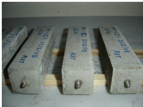
Figura 3.28 - Provetes prismáticos com respectivos pernos metálicos nas extremidades
