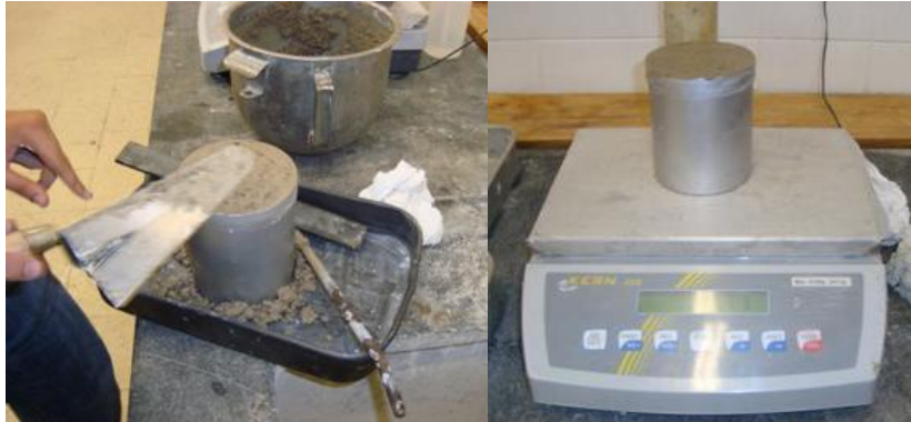
Figura 3.20 - Alisamento da superfície da argamassa e pesagem do conjunto "recipiente+argamassa"
