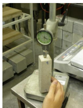
Figura 3.31 - Rotação longitudinal do provete
