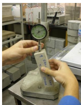
Figura 3.30 - Introdução do topo do provete no aparelho de medição
