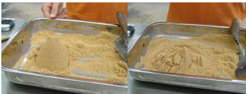
Figura 3.17 - Secagem da superfície da areia no ensaio de absorção de água
