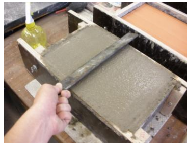
Figura 3.11 - Regularização da superfície do reboco usando uma régua metálica
