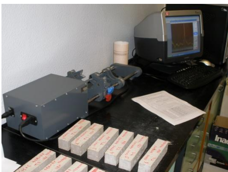
Figura 3.25 - Aparelho utilizado na medição do módulo de elasticidade dinâmico
