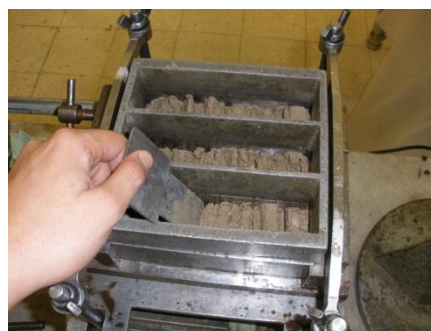
Figura 3.5 - Utilização da espátula metálica para homogeneizar as camadas de argamassa
