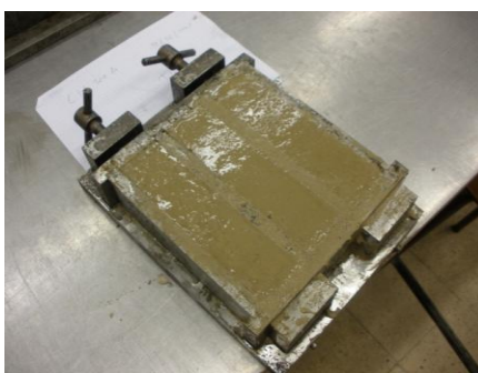
Figura 3.6 - Aspecto dos provetes prismáticos ainda no molde, logo após a moldagem
