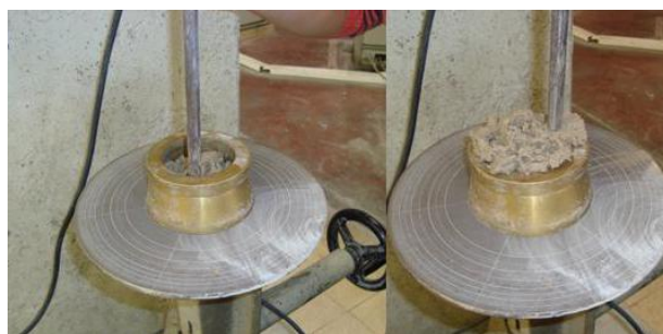
Figura 3.18 - Compactação das duas camadas de argamassa no molde tronco-cónico
