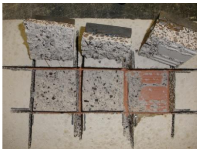
Figura 4.34 - Provete de ensaio da argamassa CH 40A+R2 depois da execução do ensaio
