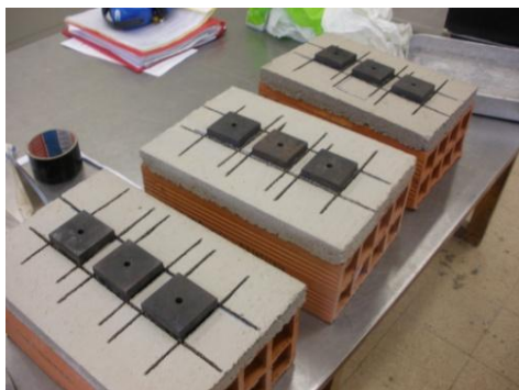
Figura 3.23 - Aspecto final das pastilhas após colagem
