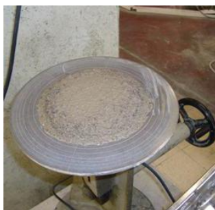
Figura 3.19 - Amostra de argamassa após ter sido submetida ao ensaio
