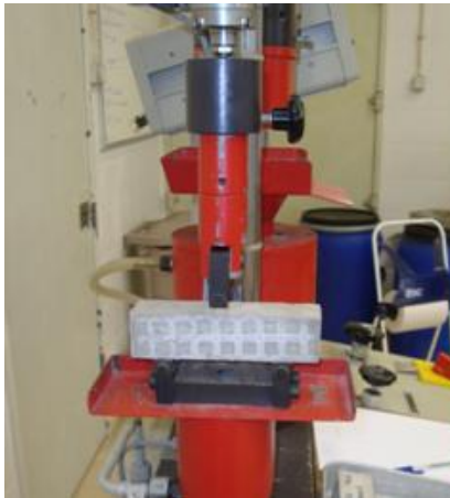
Figura 3.21 – Máquina de ensaio com provete pronto a ser ensaiado à flexão, à esquerda, e esquema de colocação do provete, à direita (imagem retirada da norma EN 1015 – 11:1999)
