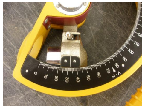
Figura 3.35 - Leitura do ressalto na escala graduada do aparelho
