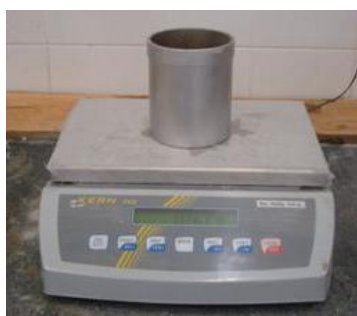
Figura 3.14 - Provette utilizado no ensaio da massa volúmica aparente dos agregados
