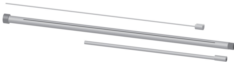
Figura 3.15. Visualização 3D do queimador tubular e do material para as intervenções estruturais.
