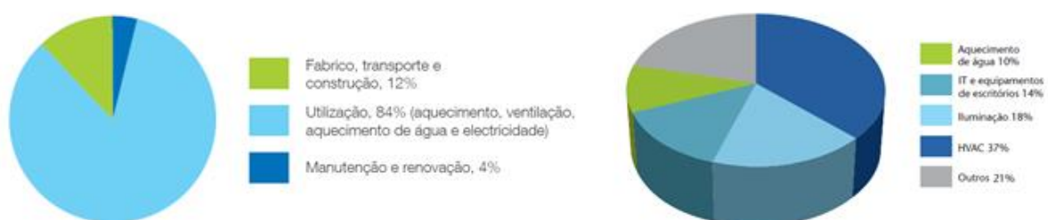
Figura 1.2 - Ciclo de vida de utilização de energia num edifício e consumo de energia por setores (Caldas, 2010)
