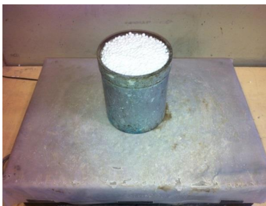
Figura 3.6 - Pesagem do granulado de EPS
