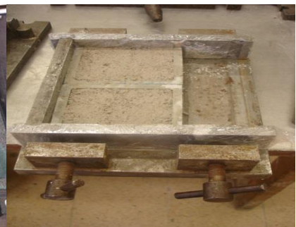
Figura 3.16 - Moldes dos provetes para o Isomet 2114
