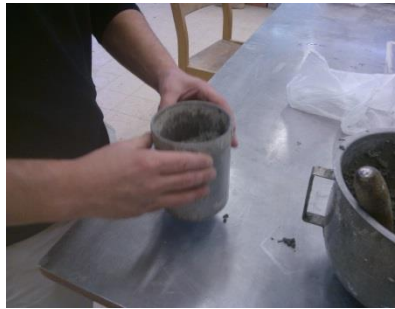
Figura 3.28 - Compactação da primeira camada da argamassa fresca
