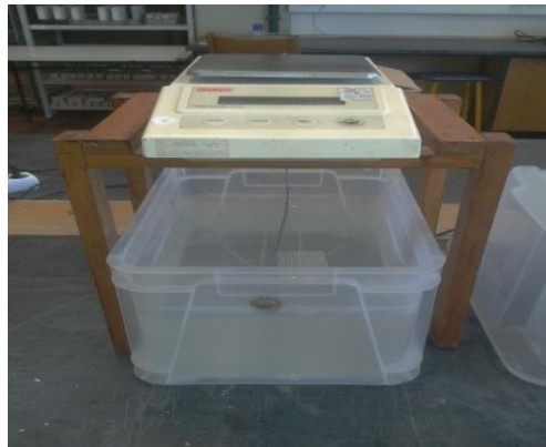
Figura 3.34 - Pesagem hidrostática para obtenção da massa M_2
