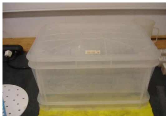
Figura 3.39 - Tina coberta para evitar a evaporação de água
