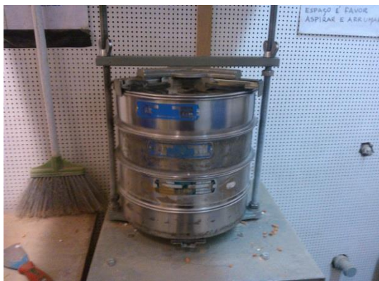
Figura 3.4 - Peneiração do granulado de cortiça
