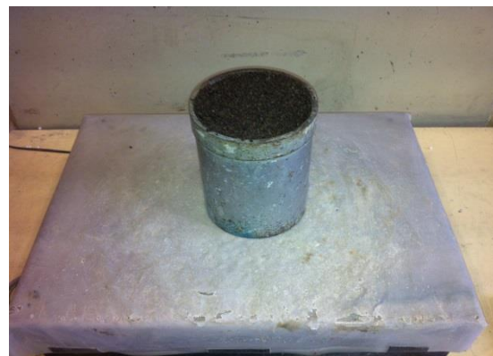
Figura 3.5 - Pesagem do granulado de cortiça
