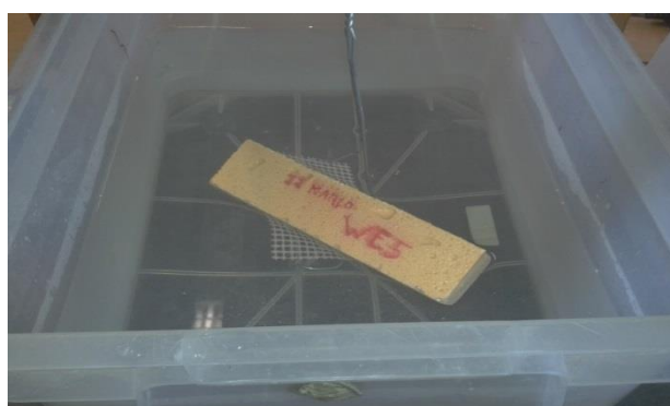
Figura 4.1 - Provete a flutuar quando colocado em água
