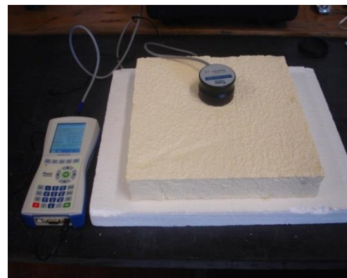
Figura 4.15 - Provetes tipo 2 ensaios com o Isomet 2114
