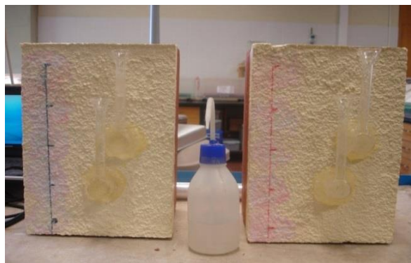
Figura 3.36 - Ensaio do tubo de Karsten
