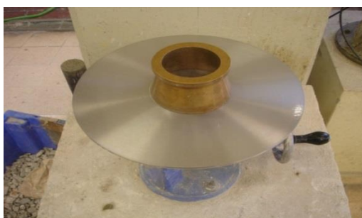
Figura 3.23 - Molde centrado com o disco
