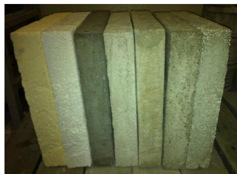
Figura 3.42 - Provetes 300 x 300 x 50 mm 3 de todas as argamassas
