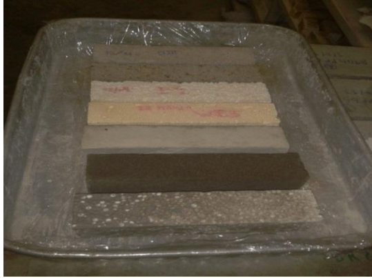
Figura 3.35 - Ensaio de secagem nos provetes prismáticos normalizados
