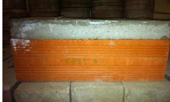
Figura 3.22 - Camada de 4 cm de argamassa sobre o tijolo
