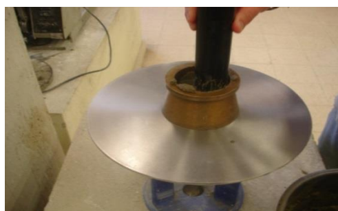
Figura 3.24 - Compactação da primeira camada do molde
