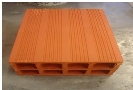
Figura 3.20 - Tijolo com furação horizontal
