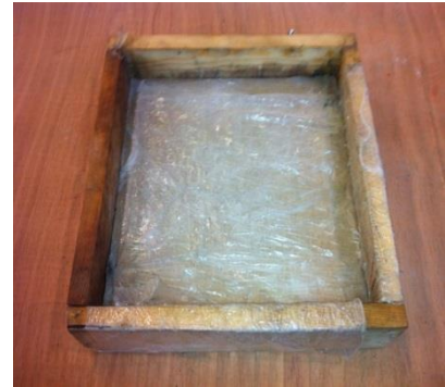
Figura 3.19 - Molde construído no laboratório
