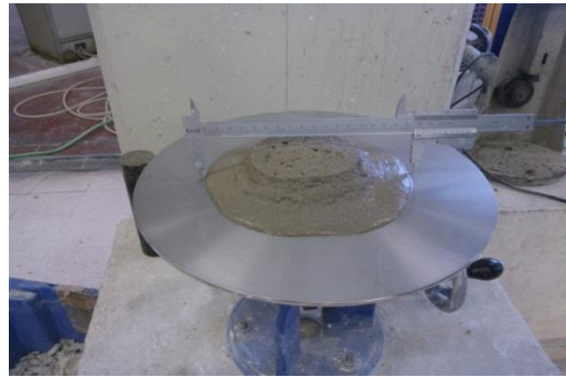
Figura 3.26 - Medição do diâmetro da argamassa espalhada
