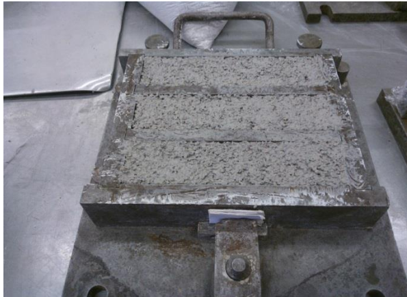
Figura 3.13 - Moldes com 3 provetes prismáticos
