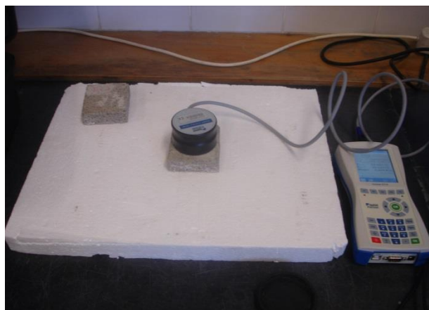
Figura 3.40 - Medição da condutibilidade térmica com o equipamento Isomet 2114
