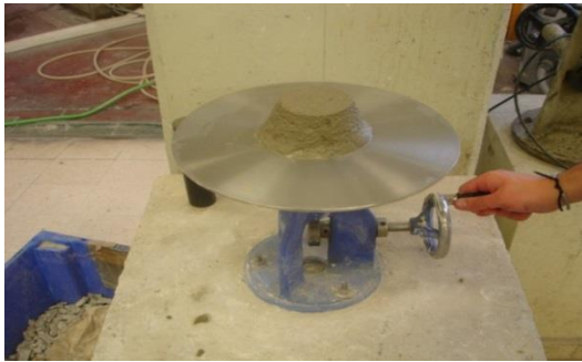
Figura 3.25 - Rotação manual do manípulo da mesa de espalhamento
