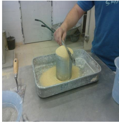
Figura 3.2 - Nivelamento da superfície
