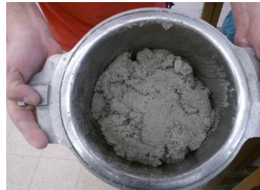
Figura 3.12 - Repouso da argamassa
