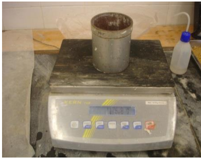
Figura 3.27 - Massa do copo cilíndrico
