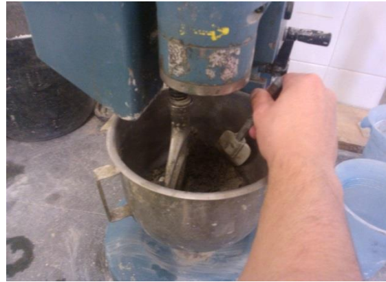
Figura 3.8 - Remoção do material aderente às paredes do recipiente
