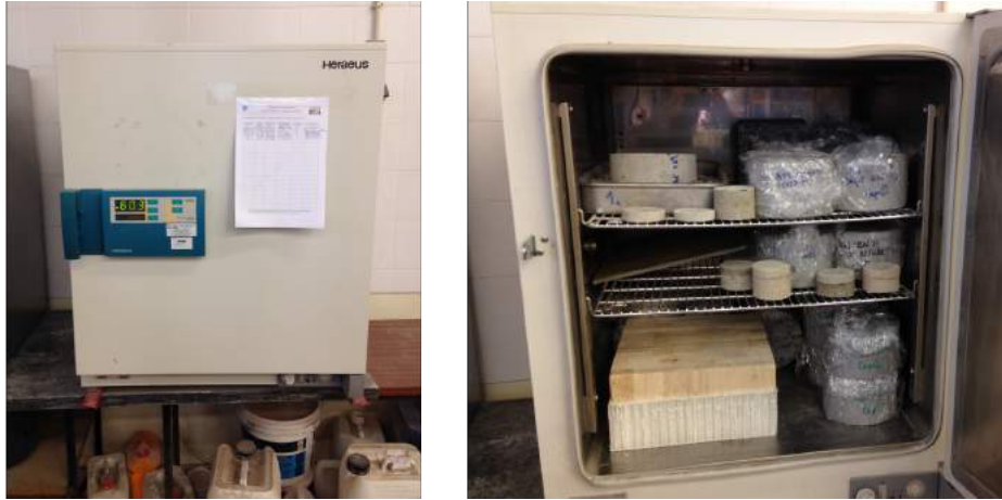
Figura 3.9 - Estufa a 60°C ventilada para o exterior com pormenor do interior.
