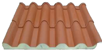
Figura 2.2 - Painel sanduíche para cobertura inclinada com lâminas metálicas e núcleo de poliuretano [11].
