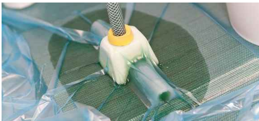
Figura 2.15 - Processo de fabrico de moldagem por infusão a vácuo [25].
