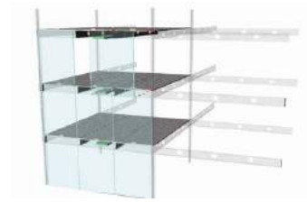
Figura 2.3 - Painel sanduíche para piso estrutural com lâminas metálicas e núcleo de poliuretano [12].
