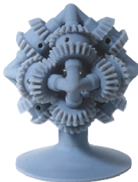
Fig. 1: Exemplo de objecto impresso com recurso à modelação tridimensional. Devido à sua complexidade, não seria possível a sua criação manual como peça única. (Fonte: Proto3000.com (2013))
