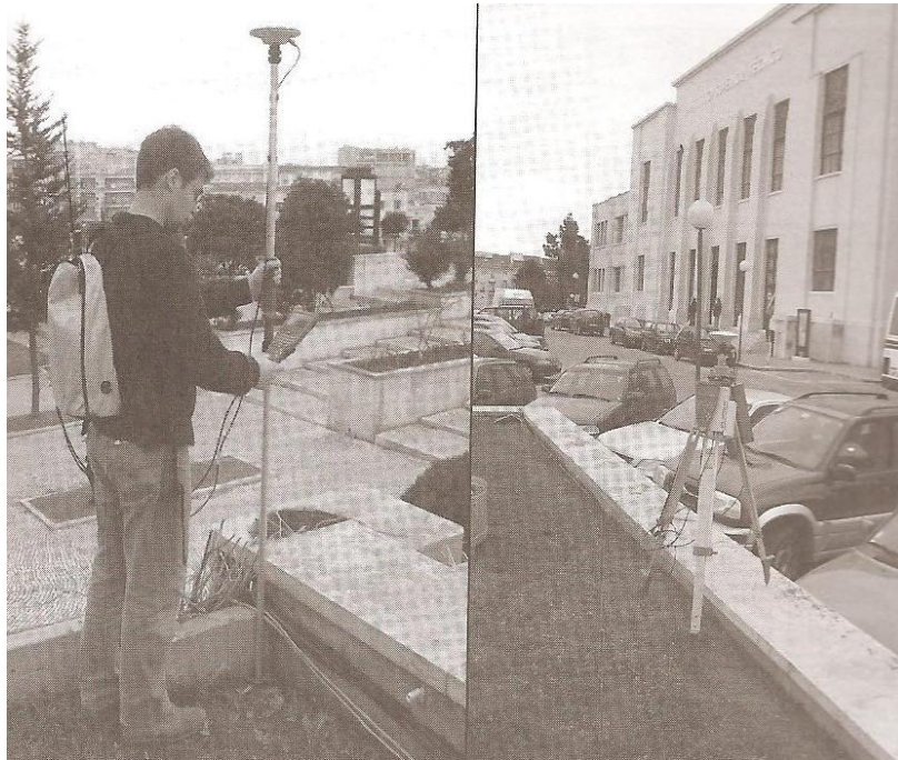
Figura 3.3 Método de medição local (GPS Diferencial) (fonte: Casaca, et al., 2005).
