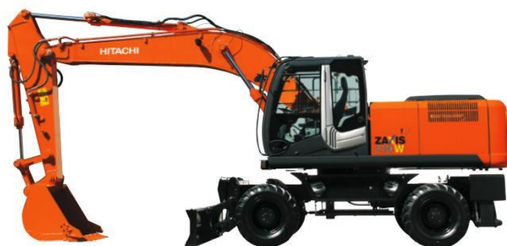
Figura 2: Escavadora de rodas. (7)
