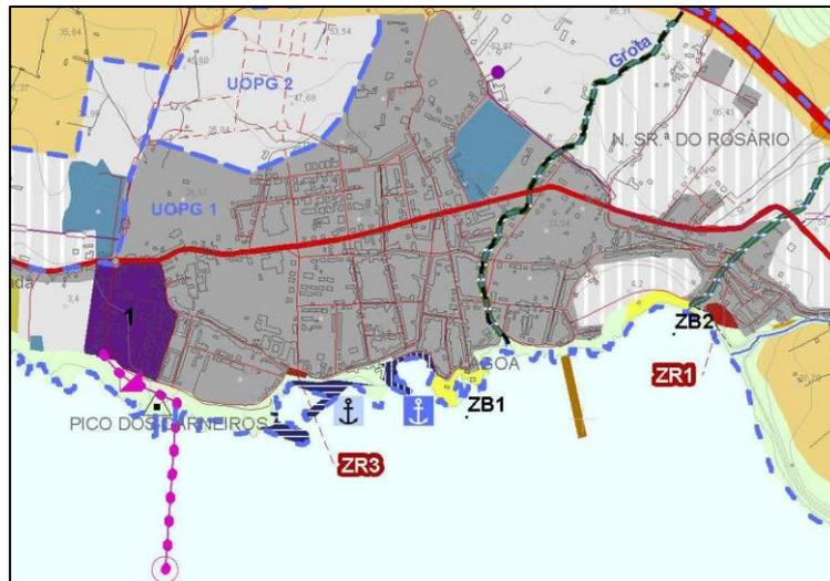
A zona de risco identificada na freguesia da Ribeira Chã encontra-se assinalada com uma circunferência de cor vermelha, dizendo respeito a uma área habitacional localizada no topo de um talude instável, com acentuado declive e materiais de natureza desagregada, pelo que existe o risco da ocorrência de movimentos de massa de vertente e desmoronamento das estruturas aí presentes.
