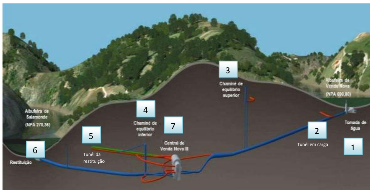
Figura 27- Representação da implementação da central de Venda Nova III e sua constituição (adaptado da Memória Descritiva - Projeto).
