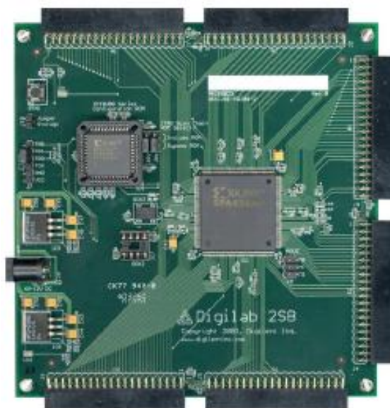
Figura 3.1: Placa D2-SB . Peça central, contém a FPGA a programar.
