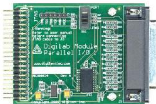
Figura 3.3: Placa PIO1 . Fornece um meio de comunicação através de uma porta paralela.
