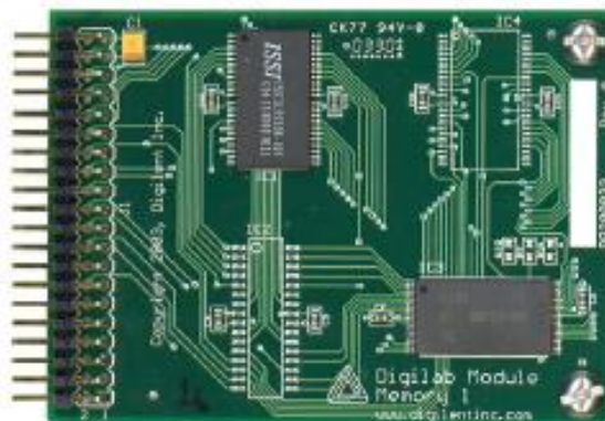
Figura 3.4: Placa MEM1 . Encarregada de fornecer de uma memória flash ao conjunto.
