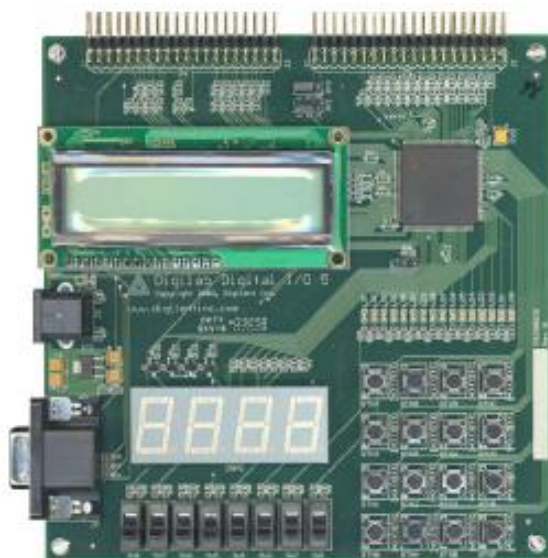
Figura 3.2: Placa DIO5 . Contém os dispositivos de entrada e saída.
