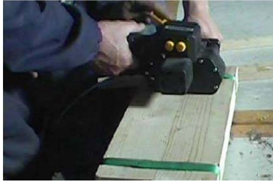
Figura 10 - Aperto recorrendo a fitas plásticas [12]
