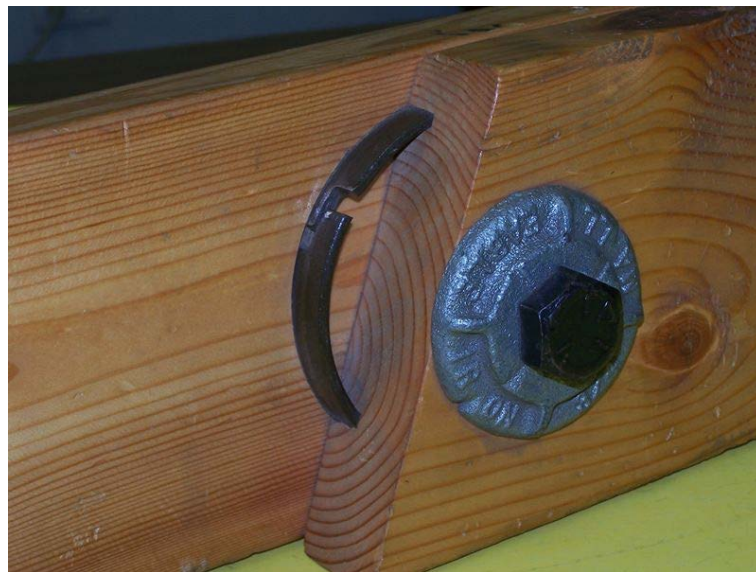
Figura 47 – Demonstração de ligação anelar (parcialmente cortada) [50]
