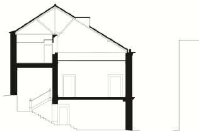
Figura 49: Corte transversal do corpo principal do Palácio. Corte feito pelas escadarias nobres. Neste corte é visível a diferença de cota entre o beirado da fachada frontal e da fachada de tardoz. Fonte: desenho do autor sobre levantamento do gabinete PPST arquitectura, Lda.
