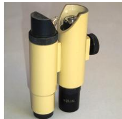
Figura 4.2 - Comparador de fissuras (à esquerda) (Cóias, 2006) e medidor óptico (à direita) (Cóias, 2006)
