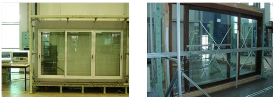
Figura 2.2 - Câmara de ensaios para a realização dos ensaios de permeabilidade ao ar estanqueidade à água e resistência ao vento (à esquerda) e equipamento para a realização dos ensaios mecânicos (à direita) (LNEC, 2012)
