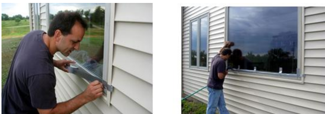
Figura 4.8 - Concepção do canal utilizando fita adesiva impermeável (à esquerda) e enchimento do canal com água (à direita) (Window Inspections, 2012)
