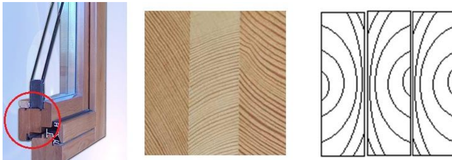
Figura 2.17 - Caixilharia de madeira lamelada: tem um comportamento mais homogéneo e mais isotrópico, permitindo variações dimensionais muito pequenas (evita o empenamento) [adaptado de MCMurta (2012)]
