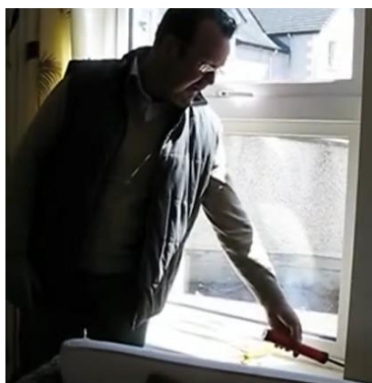
Figura 4.10 - Detecção de fugas de ar pela caixilharia (IEA, 2012)
