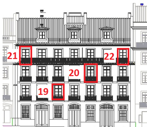
Figura 5.1 - Exemplo de mapeamento das caixilhariarias na fachada
