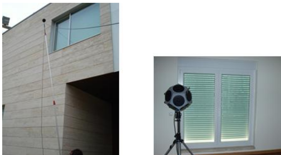
Figura 4.14 - Sonómetro - elevado por acção de uma vara metálica (à esquerda) e fonte sonora dodecaédrica (à direita) (WISE, 2012)
