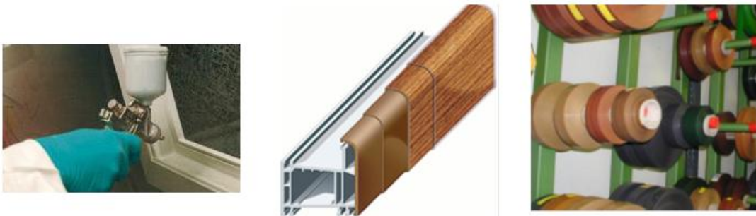
Figura 2.24 - Lacagem (à esquerda), aplicação de película (ao centro) e tipos de películas (à direita) (Gomes, 2011)
