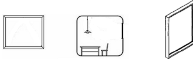
Figura 2.3 - Janela fixa (alçado, forma de ventilação e perspectiva) [adaptado de HUD (1999) e ABAL (2012)]
