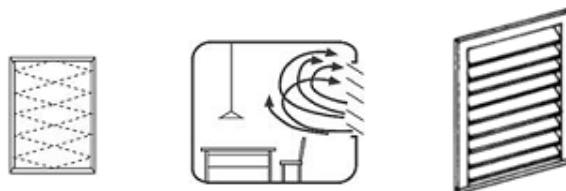
Figura 2.12 - Janela vitrô (alçado, forma de ventilação e perspectiva) [adaptado de HUD (1999) e ABAL (2012)]
