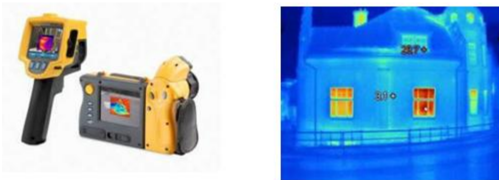
Figura 4.17 - Exemplos de câmaras termográficas (à esquerda) e termograma obtido durante uma análise termográfica (à direita) (Fluke Corporation, 2011)
