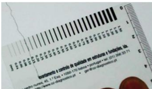
Figura 4.2 - Comparador de fissuras (à esquerda) (Cóias, 2006) e medidor óptico (à direita) (Cóias, 2006)
