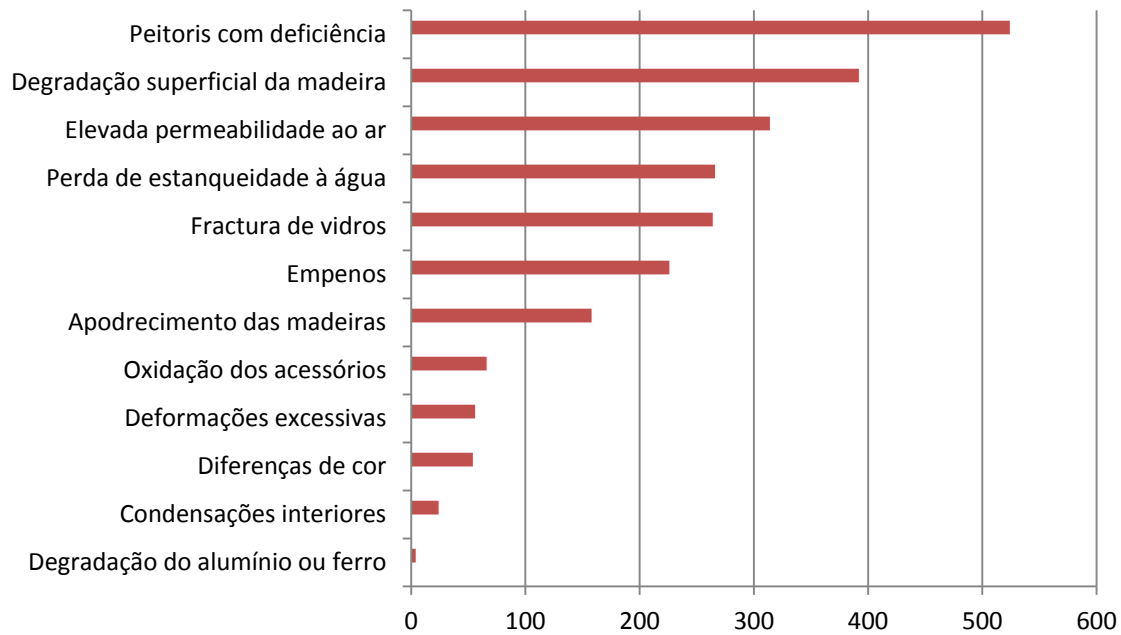
Figura 3.1 - Frequência das anomalias das caixilharias dos edifícios da Baixa de Coimbra (Ramos, 2009)
