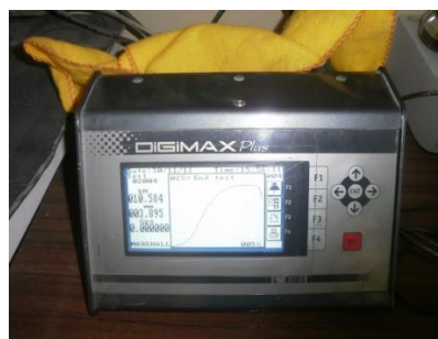
Figura 3.10 – Exemplo de curva força-deformação registada no equipamento de aquisição de dados (Digimax)
