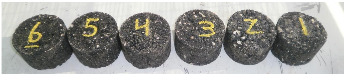
Figura 3.15 – Provetes preparados para o ensaio de sensibilidade à água
