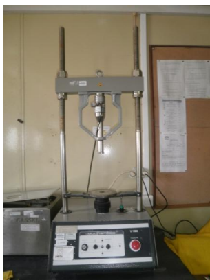
Figura 3.11 – Equipamento utilizado no ensaio de compressão Marshall
