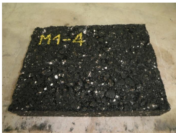
Figura 3.27 – Laje para o ensaio de pista após compactação
