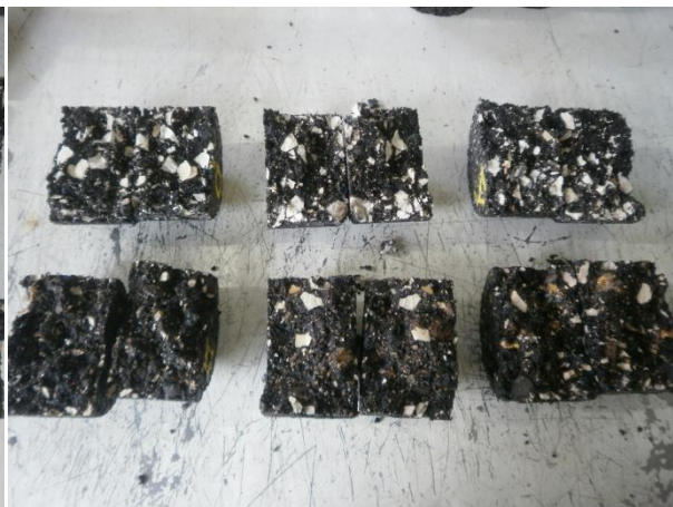
Figura 3.21 - Provetes fabricados com a mistura M2, após ruptura no ensaio ITSr
