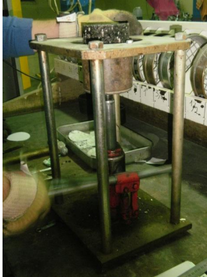
Figura 3.6 – Desmoldagem do provete
