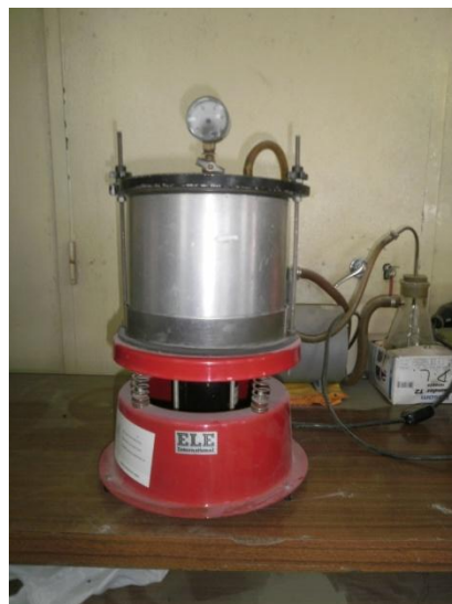
Figura 3.8 – Picnómetro de vácuo com agitador
