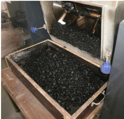
Figura 3.24 – Preparação da mistura para o fabrico da laje do ensaio de pista
