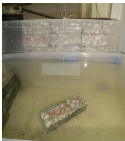
Figura 3.32 - Pesagem da viga submersa em água
