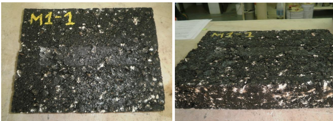
Figura 3.29 – Laje após ensaio de pista
