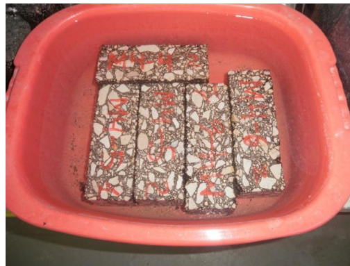
Figura 3.31 – Vigas imersas em água
