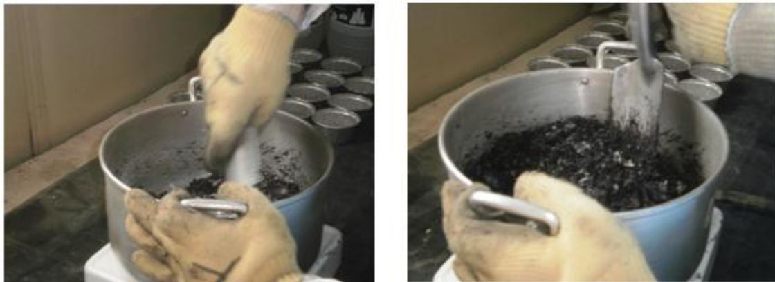
Figura 3.4 – Fabrico da mistura em recipiente de alumínio sobre placa elétrica
