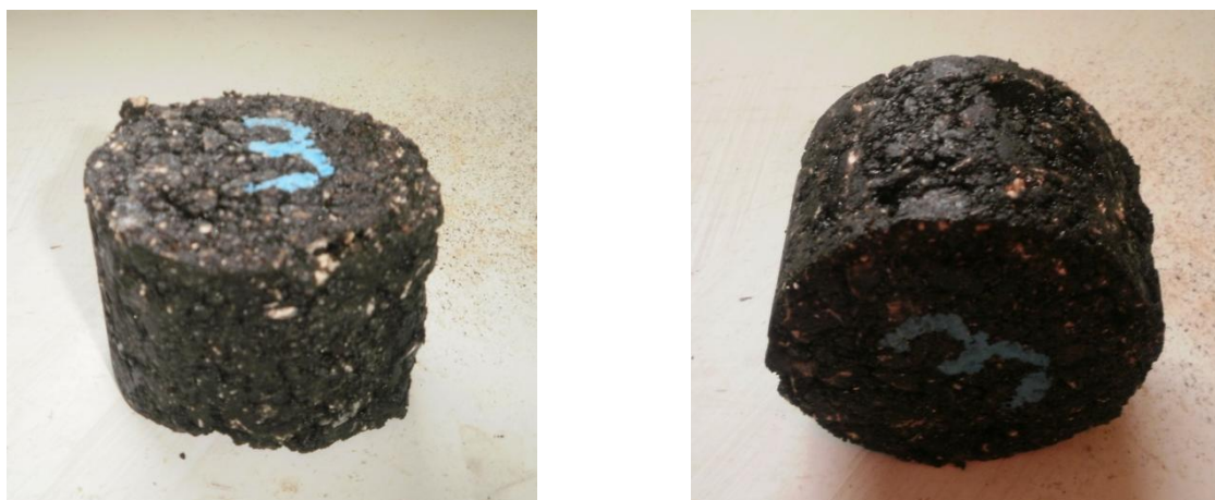
Figura 3.14 - Provete após o ensaio de compressão Marshall
