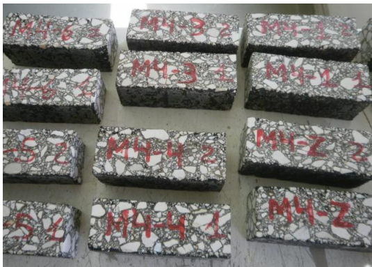
Figura 3.30 – Vigas cortadas das placas após ensaio
