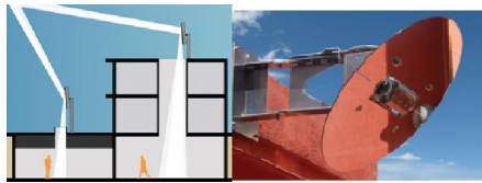
Fig. 3.3.1.11.9. Exemplo de diferentes sistemas de captação de luz natural – Fibra Óptica, Tubo de Luz e Poço de luz
