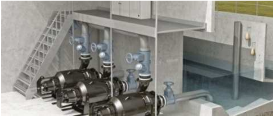
FIGURA XII: Estação elevatória de lamas
