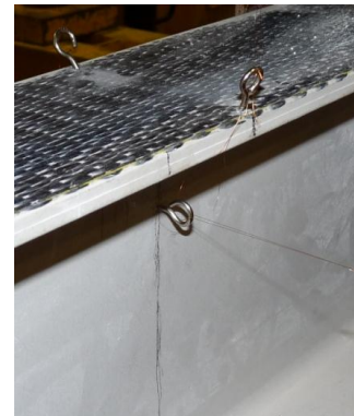
Figura 4.88. Fixação dos deflectómetros de fio ao banzo superior e à alma
