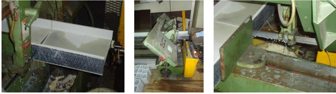
Figura 4.3. Serra eléctrica com refrigeração utilizada nos cortes transversais
