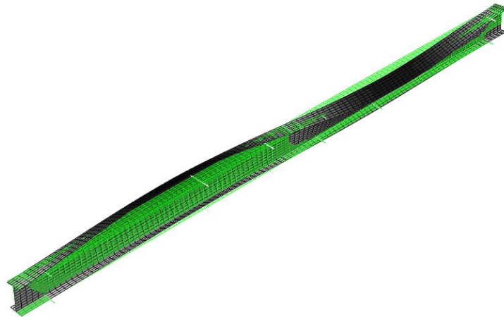
Figura 5.65. Configuração deformada do primeiro modo de instabilidade da viga calibrada.
