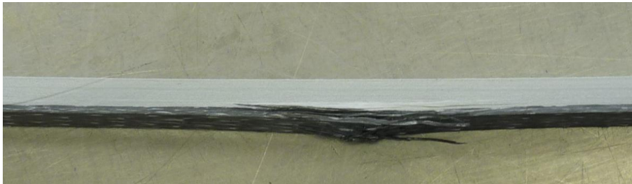
Figura 4.14. Modo de rotura de um provete do banzo com a manta de CFRP traccionada
