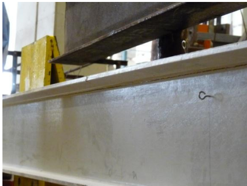
Figura 4.94. Rotura na ligação banzo-alma sob o ponto de aplicação do carregamento
