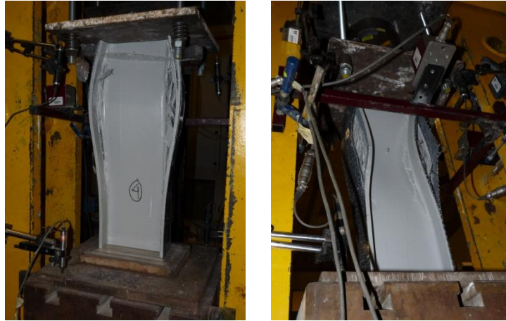
Figura 4.66. Rotura na ligação banzo-alma de colunas curtas comprimidas
