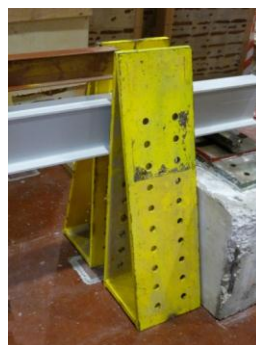
Figura 4.85. Travamento com apoios metálicos
