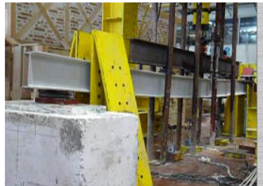
Figura 4.93. Deformada global da viga na iminência da rotura.
