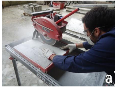
Figura 4.5. (a) Serra de disco utilizada no corte longitudinal e (b) amostras dos provetes
