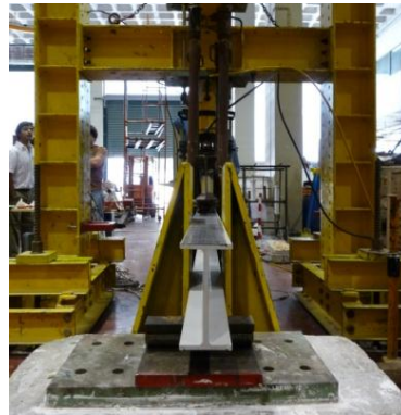
Figura 4.79. Macaco hidráulico com célula de carga Figura 4.80. Pórtico utilizado no apoio do carregamento
