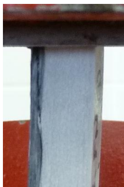
Figura 4.32. Delaminação da manta de CFRP no ensaio de compressão
