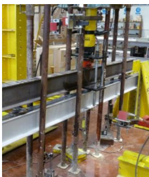
Figura 4.84. Travamento com prumos metálicos
