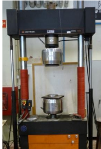
Figura 4.36. Prensa Instron utilizada no ensaio de tracção
