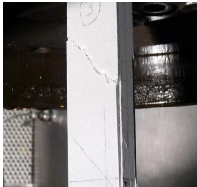
Figura 4.49. Rotura por corte no ensaio de tracção com as fibras orientadas a 10°
