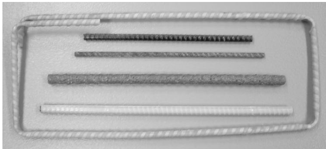
Figura 2.5. Varões de GFRP e CFRP para aplicação em estruturas de betão armado [2.3]
