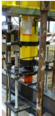
Figura 4.79. Macaco hidráulico com célula de carga Figura 4.80. Pórtico utilizado no apoio do carregamento
