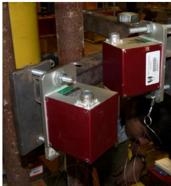
Figura 4.87. Deflectómetros de fio utilizados na medição dos deslocamentos verticais do banzo
