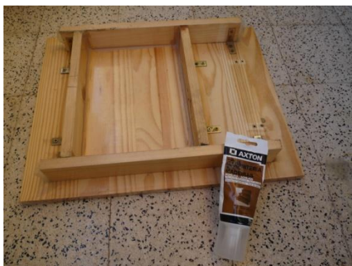
Figura II.1. Molde em madeira e selante de juntas
