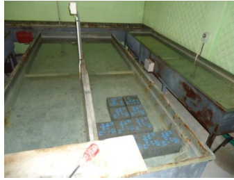
Figura 4.12 – Processo de cura dos provetes em ambiente controlado.
