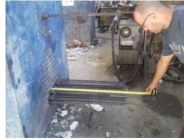
Figura 7.10 – Controlo dos valores de alongamento sofrido pelos cordões.
