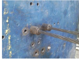
Figura 7.11 – Controlo do deslizamento das cunhas.
