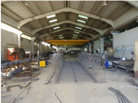
Figura 5.5 – Área de corte e dobragem das armaduras.
