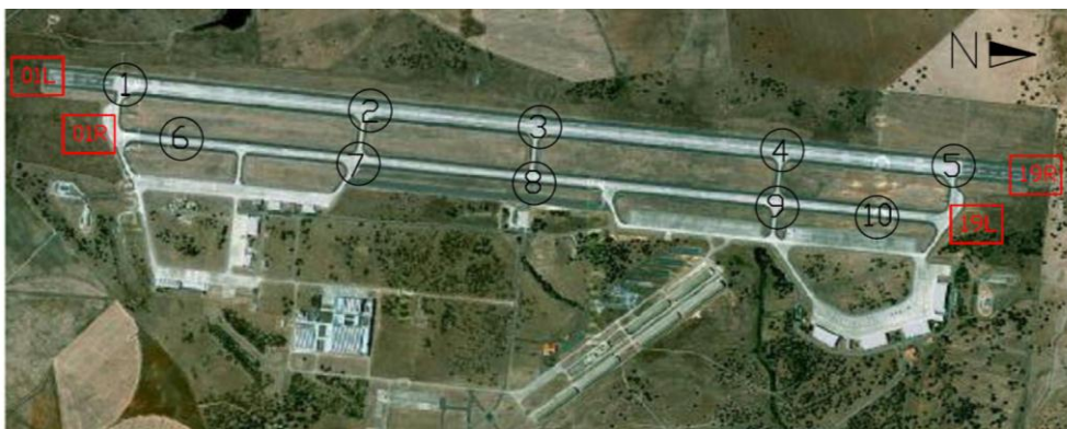
Figura 3.18 - Identificação dos alinhamentos de ensaio, da 2ª Fase, nas pistas principal e secundária.
