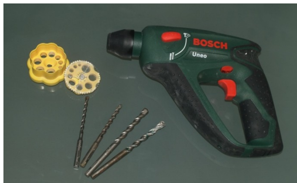
Figura 5.40 – Material utilizado na recolha de amostras de betão (arquivo pessoal).
