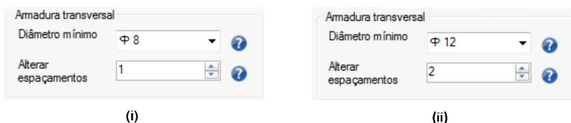
Figura 7.19 Parâmetros para as soluções de armadura transversal
