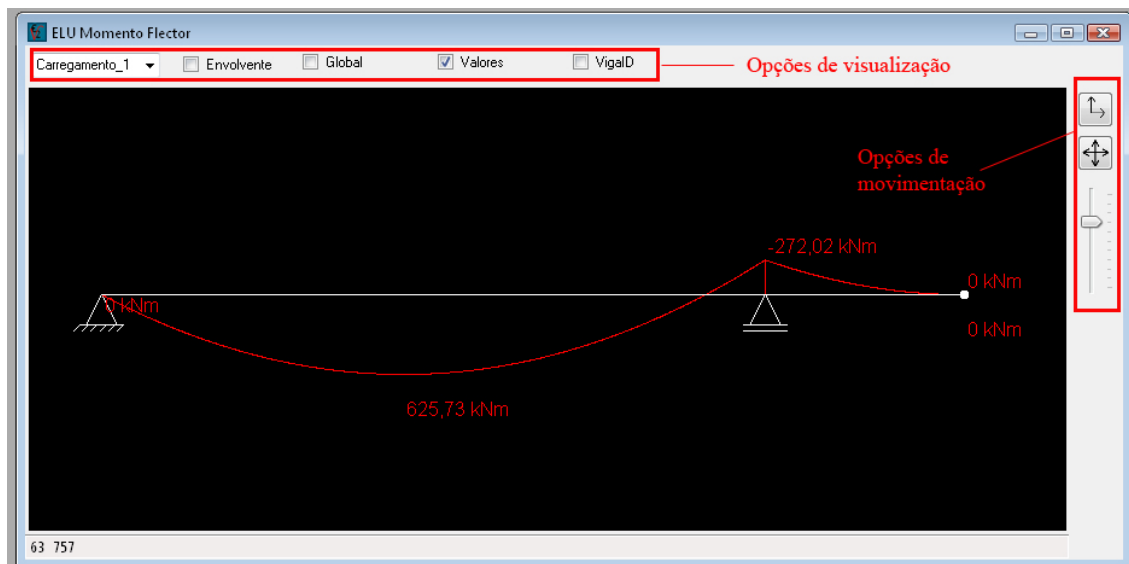
Figura 6.19 Janela ELU Momento Flector
