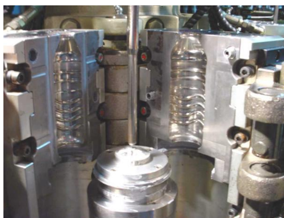
Figura 4 – Molde de sopro de pré-formas onde é visível a vareta de estiramento mecânico
