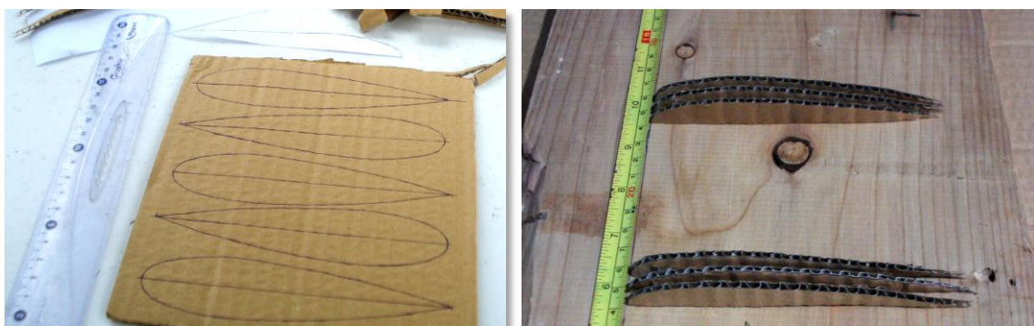
Figura 29 – Obtenção das secções em cartão canelado (esquerda) e colocação das secções alinhadas numa base para a produção do molde das pás (direita)
