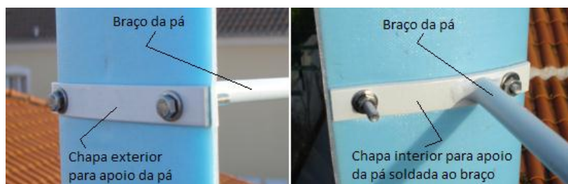
Figura 35 – Detalhe do acoplamento das pás aos braços
