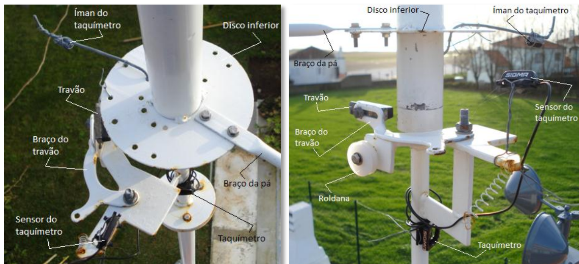
Figura 34 – Detalhe do apoio do taquímetro, travão e braços das pás
