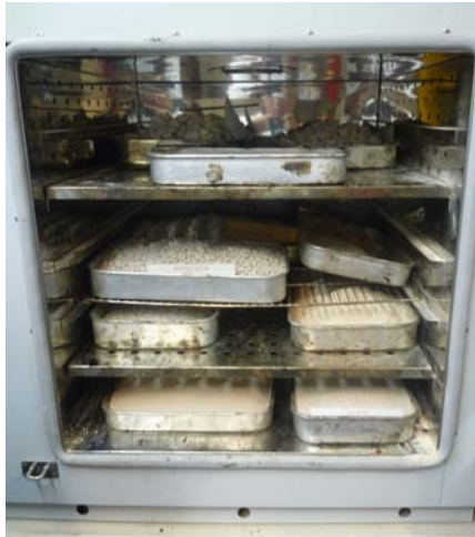
Figura 3.8 – Tabuleiros com agregados na estufa a 120°C
