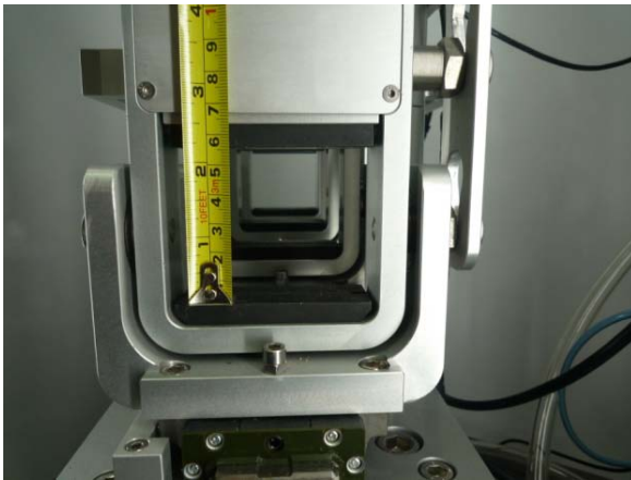
Figura 3.16 – Detalhe da abertura máxima nos dispositivos de fixação
