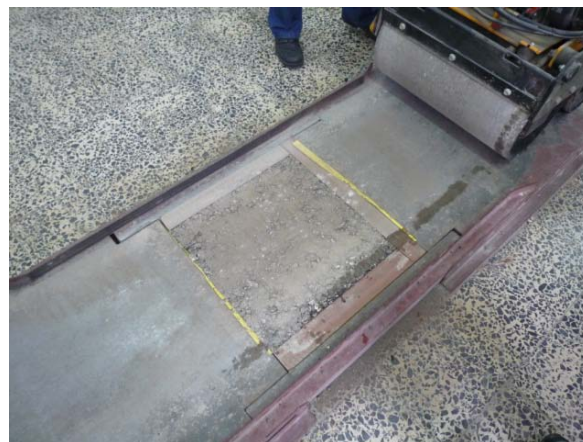
Figura 3.13 – Laje rasante com o molde depois de feita a compactação
