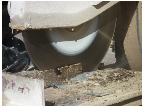
Figura 3.17 – Corte dos provetes para rebaixamento da sua altura
