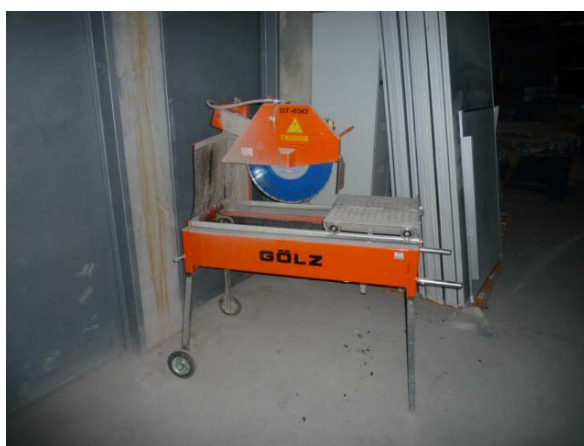
Figura 3.14 – Máquina usada para corte das lajes
