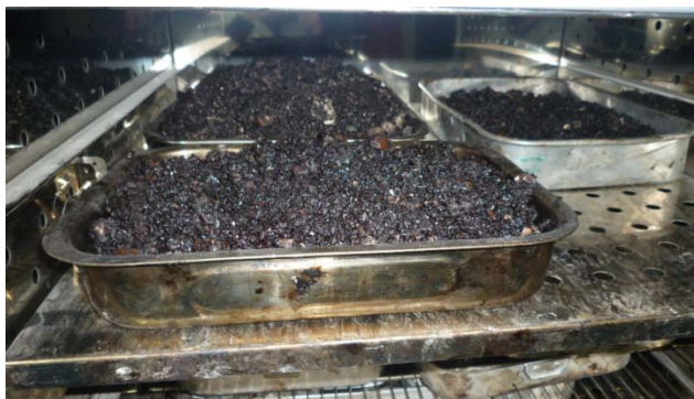
Figura 3.10 – Tabuleiros com mistura na estufa a 120°C
