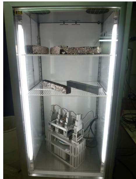
Figura 3.2 – Unidade de flexão no interior da câmara climática
