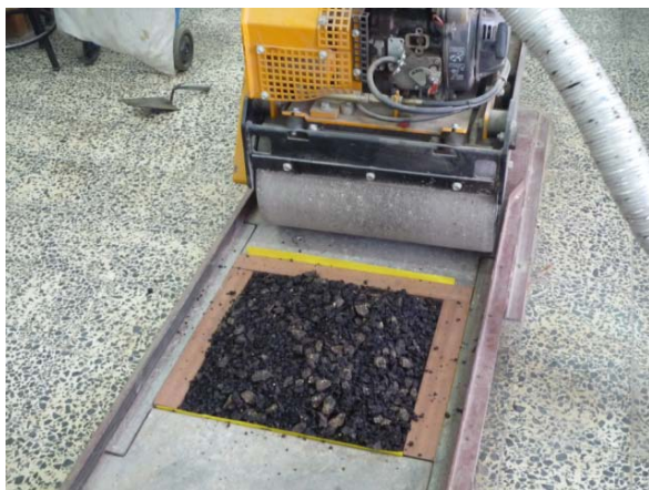
Figura 3.12 – Mistura espalhada no molde antes do início da compactação
