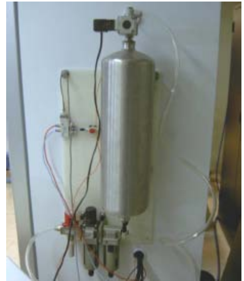
Figura 3.4 – Reservatório de ar comprimido (Crucho, 2011)
