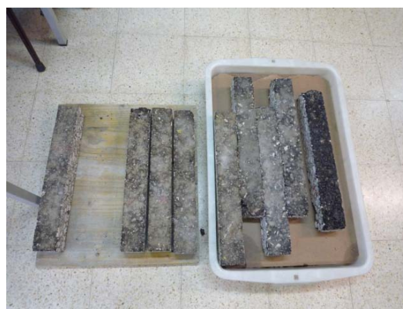
Figura 3.15 – Lajes cortadas em provetes
