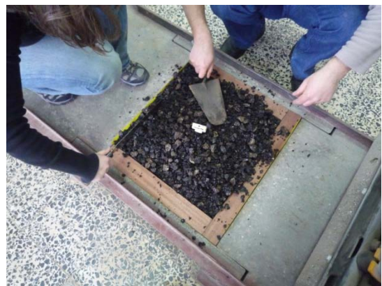
Figura 3.11 – Espalhamento da mistura no molde
