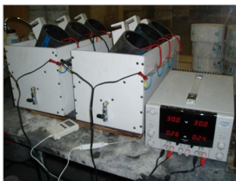
Figura 3.21 – Montagem final dos tanques de ensaio de migração de cloretos.
