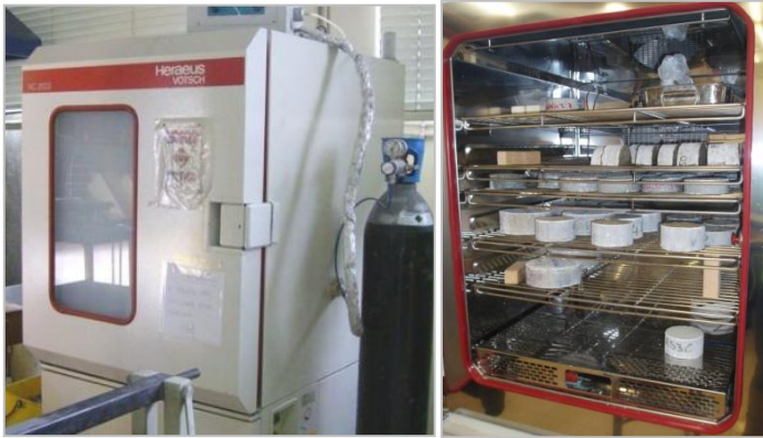
Figura 3.17 – Aspecto exterior e interior da câmara de carbonatação acelerada.
