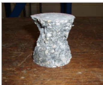
Figura 4.4 – Rotura tipo dos provetes de ensaio.
