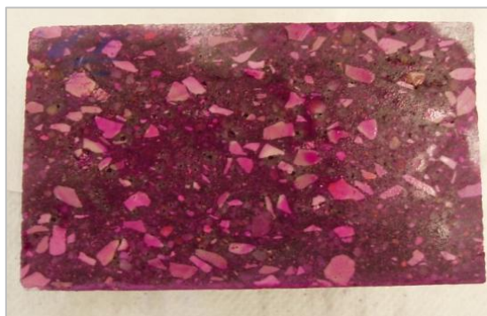
Figura 4.9 – Carbonatação inicial tipo dos provetes de ensaio.
