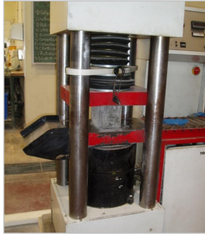
Figura 3.15 – Ensaio de resistência à compressão dos cubos.
