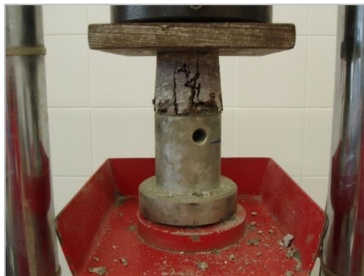
Figura 3.14 – Ensaio de resistência à compressão dos provetes cilíndricos.
