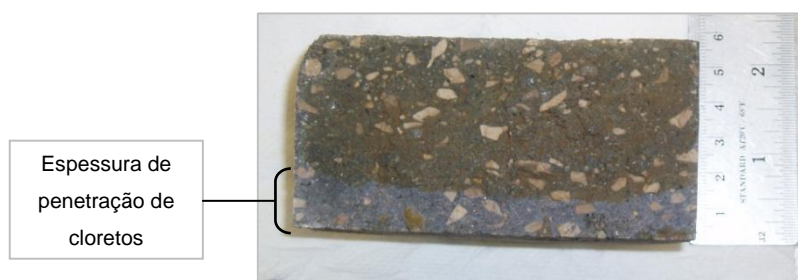
Figura 3.23 – Profundidade de penetração de cloretos de um provete tipo.
