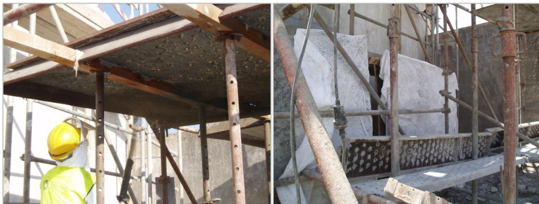
Figura 3.6 – Direcção de colocação dos painéis de ensaio: (a) horizontal e (b) vertical.
