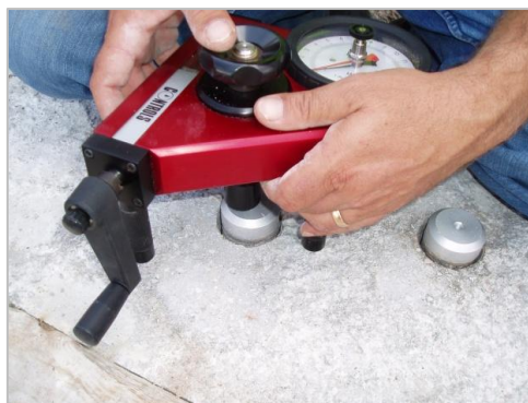
Figura 3.10 – Máquina de ensaios de arrancamento – pull-off .
