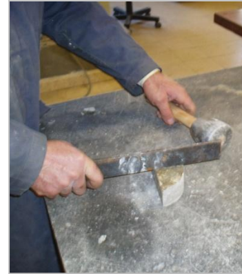
Figura 3.18 – Fractura dos provetes com martelo e escopro.
