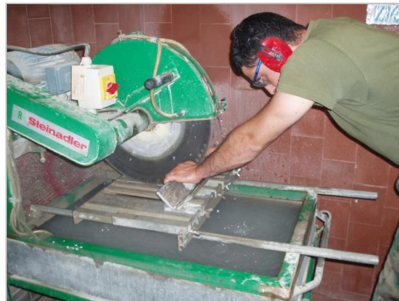
Figura 3.13 – Corte das carotes com serra de disco.
