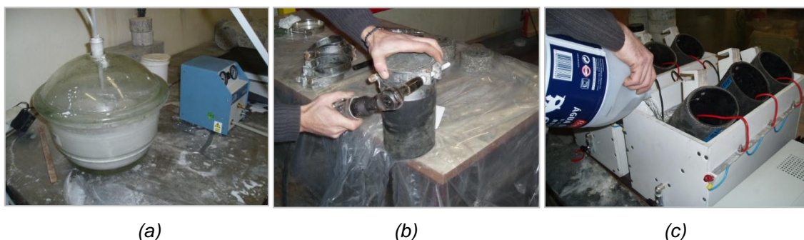
Figura 3.20 – Etapas da metodologia de ensaio à penetração de cloretos por migração: (a) câmara de vácuo, (b) montagem das mangas e (c) introdução das soluções anódica e catódica.
