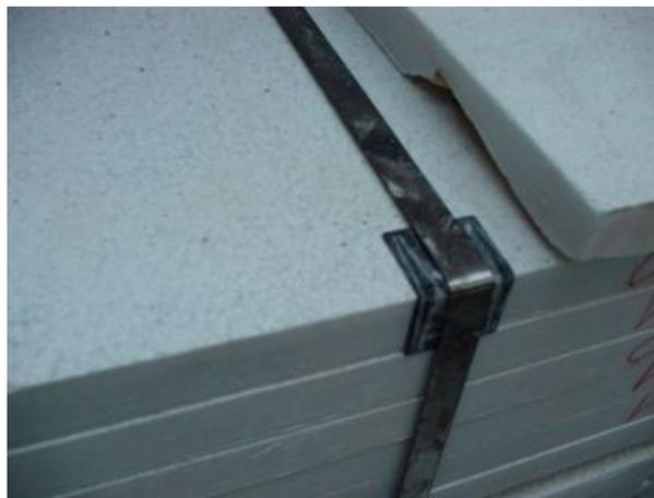
Fig 7.17 - Pormenor da protecção em plástico para evitar o contacto das pedras com o metal
