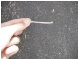
Fig 7.8 - Exemplo de um pino demasiado curto e sem batente utilizado na obra
