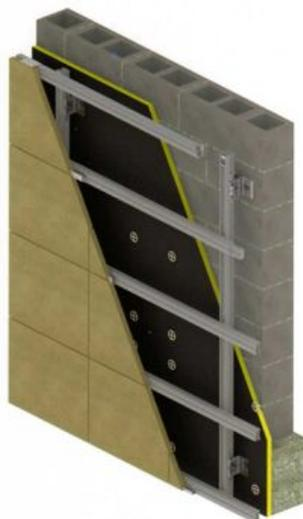
Fig 2.12 - Exemplo de estrutura de suporte intermédia composta por grelha de perfis verticais e horizontais com suporte das pedras através de calhas [24]
