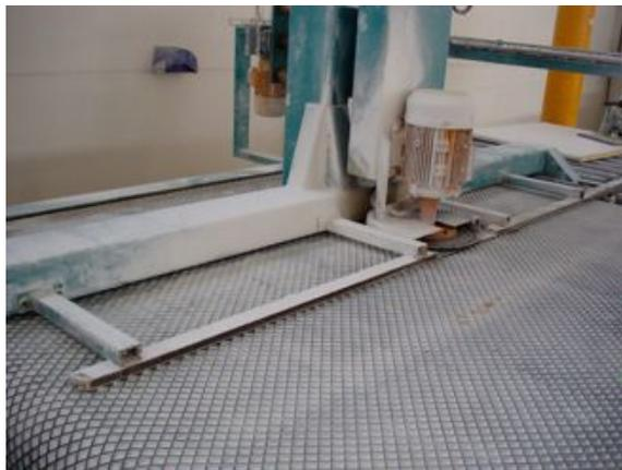
Fig 3.27 - Máquina para realizar as calhas nos topos das placas de pedra
