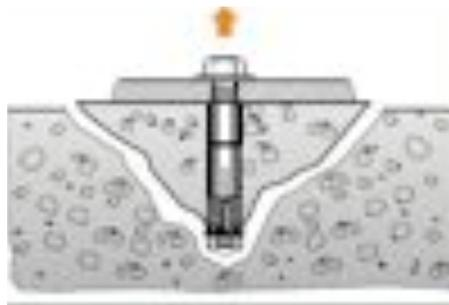
Fig 4.8 - Esquema que ilustra o desprendimento do fixador metálico provocado pela falha no suporte onde este foi fixo [33]
