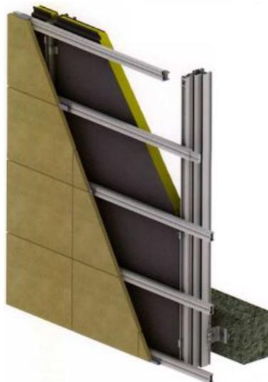
Fig 2.13 - Exemplo de estrutura de suporte intermédia fixa às lajes dos pisos composta por grelha de perfis verticais e horizontais com suporte das pedras através de calhas que dispensa as fachadas em alvenaria [24]
