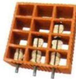
Fig 3.15 - Vista em corte do aspecto dos chumbadouros realizados com camisas plásticas no tijolo [32]
