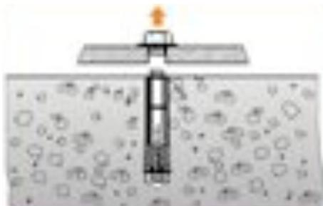
Fig 4.9 - Esquema que ilustra o desprendimento do fixador metálico provocado pela falha do próprio fixador [33]
