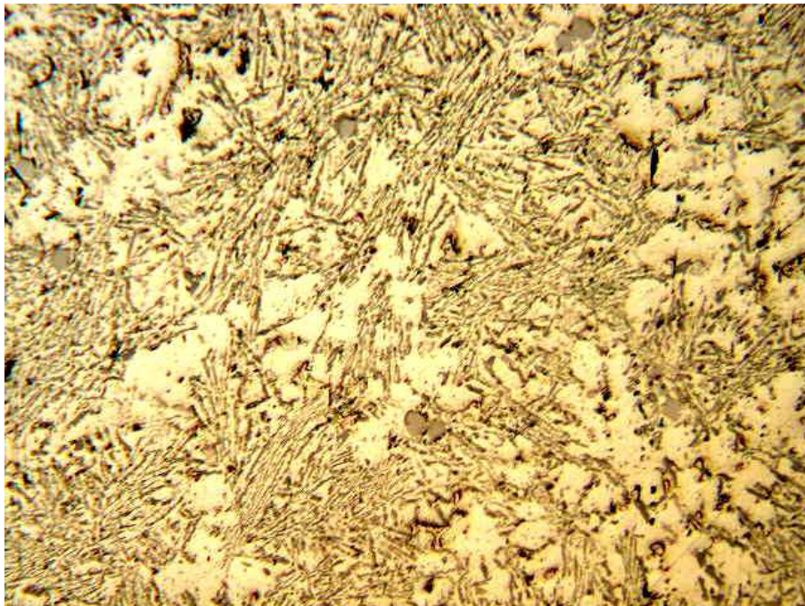
Fig. 28 - Micrografia BC1c. Observa-se fase eutética lamelar, e precipitados tipo-estrela.
