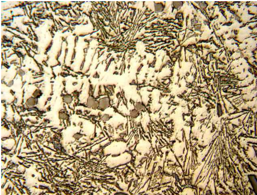
Fig. 26 - Micrografia BFF3b. Observam-se agulhas de silício, e precipitados tipo-estrela. Pelo menos dois precipitados de silício primário são visíveis.
