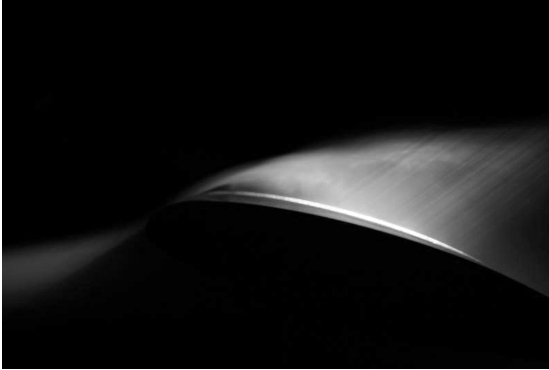
Figura 4.22: Visualização do escoamento no modelo base, 1 grau após o ângulo de ataque de perda. Note-se o escoamento completamente separado.
